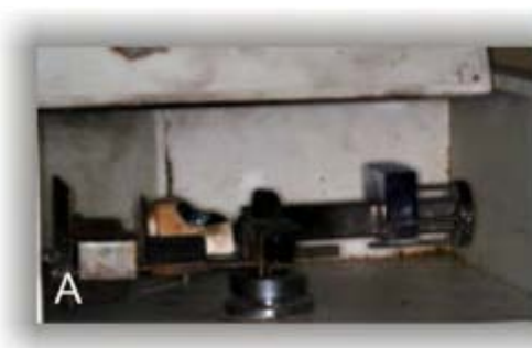
FIGURA 6 – Técnica de fundição por maçarico a) centrífuga elétrica; b) maçarico.
