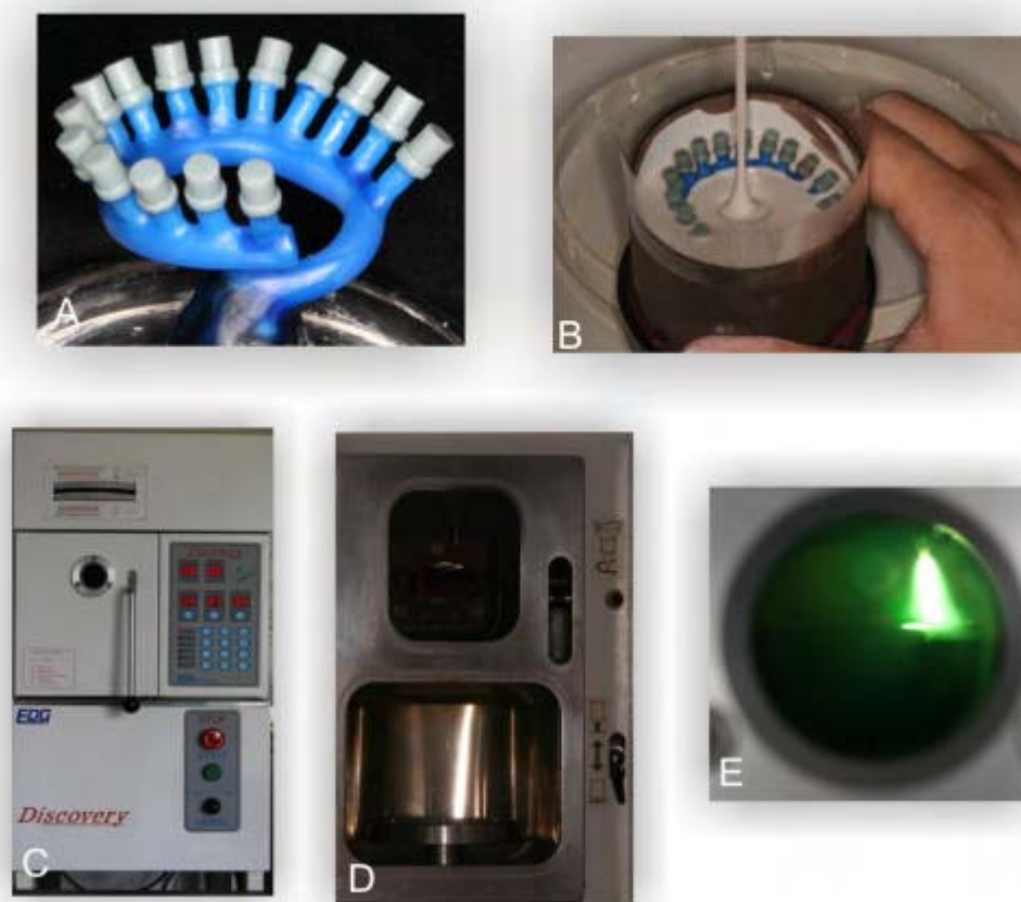
FIGURA 12 - Preparo para fundição a) CP; b) preenchimento do anel com revestimento; c) máquina de fundição por plasma; d) compartimento superior e inferior; e) descarga elétrica fundindo a liga.
