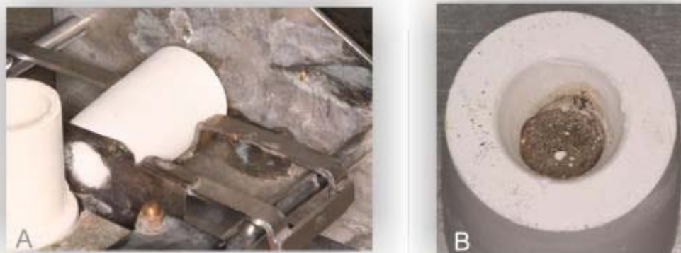
FIGURA 10 – Preparo do anel: a) anel em posição, b) após fundição
