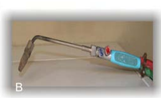
FIGURA 6 – Técnica de fundição por maçarico a) centrífuga elétrica; b) maçarico.
