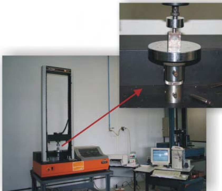
FIGURA 26- a) máquina Instron 7301 b) detalhe da máquina Instron com o dispositivo de cisalhamento.
