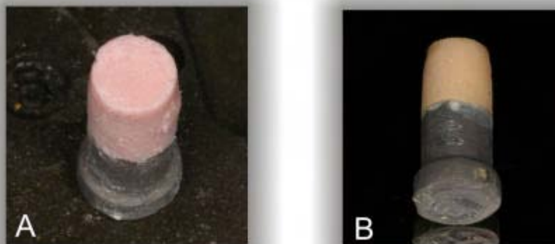
FIGURA 22 – Sinterização da segunda camada da cerâmica de corpo: a) pré-sinterização; b) pós-sinterização.
