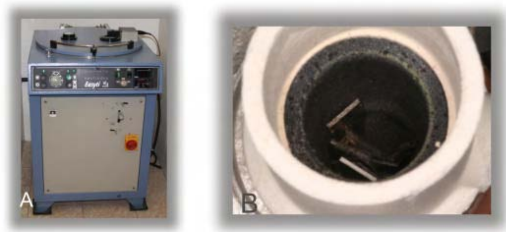
FIGURA 9 – Equipamentos utilizados para indução: a) máquina de fundição por indução; b) cadinho com liga metálica
