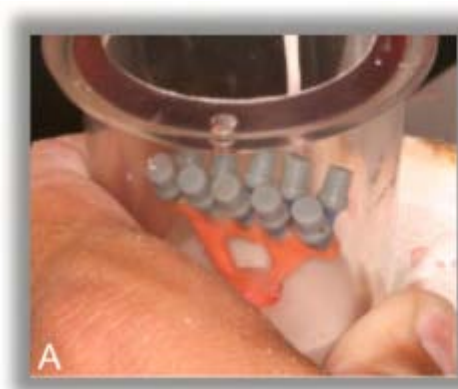
FIGURA 5 – Revestimento: a) Inclusão; b) Recorte do anel.
