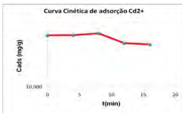
Figura 52: Cinética de adsorção do cátion metálico \text{Cd}^{2+} em bentonita leve e purificada, T= 24\pm 1 °C, 1 atm.
