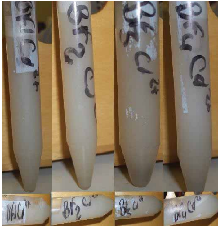
Figura 57: Estudo da formação hidrogel para bentonita leve purificada com \text{Cd}^{2+} , proporções argila/ PVA (BF1 (9:1) (BF2 (8:2); (BF3 (7:3)) (BF4 (6:4))
