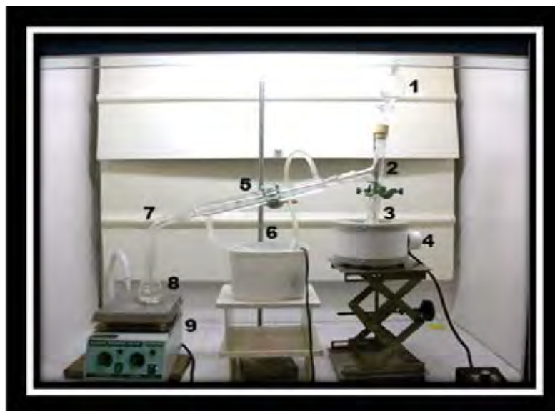
Figura 7: Aparelhagem de laboratório; [1] Funil de separação; [2] Conector em forma de ‘Y’; [3] Balão de fundo redondo com boca esmerilhada; [4] Manta aquecedora; [5] Condensador com juntas esmerilhadas; [6] recipiente contendo gelo + água líquida; [7] tubo conector cotovelo com respiro junta esmerilhada; [8] Erlenmeyer 125 mL; [9] Agitador magnético com aquecimento.
