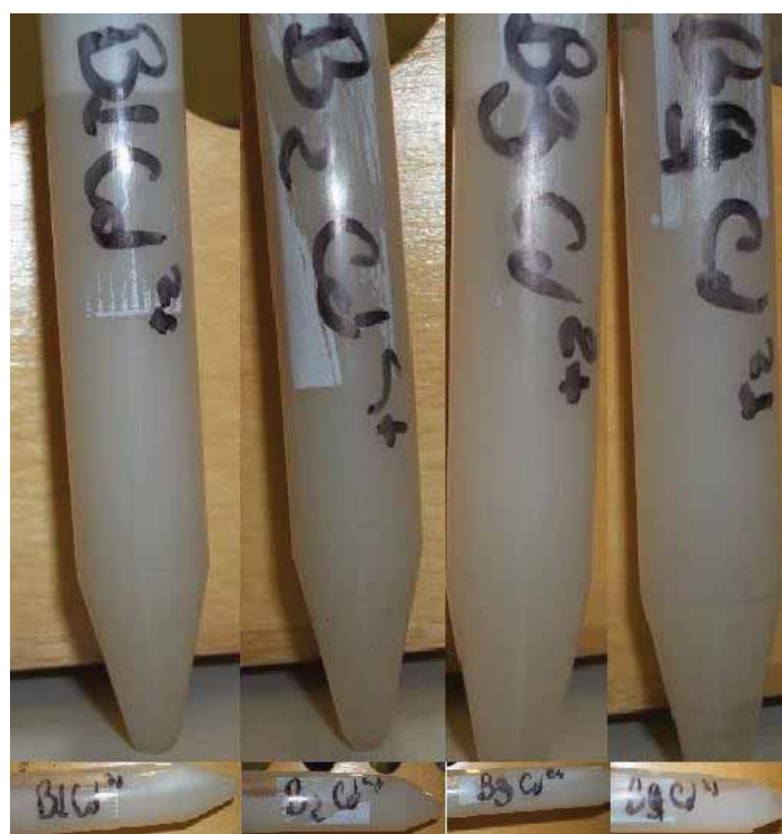
Figura 56: Estudo da formação hidrogel para bentonita não fracionada com Cd^{2+} , proporções argila/ PVA (B1 (9:1) (B2 (8:2); (B3 (7:3)) (B4 (6:4))
