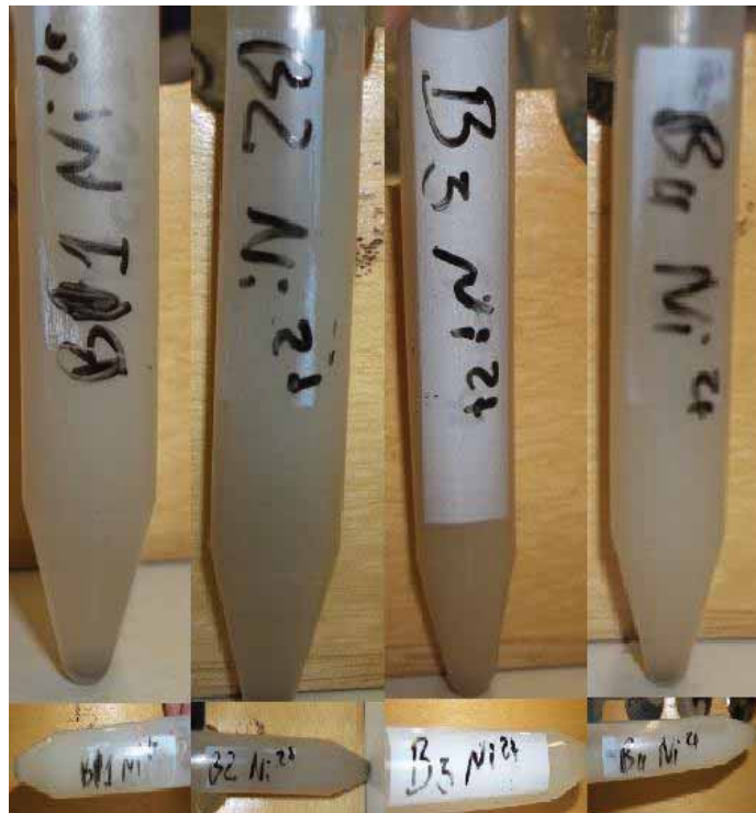
Figura 58: Estudo da formação hidrogel para bentonita não fracionada com \text{Ni}^{2+} , proporções argila/ PVA (B1 (9:1) (B2 (8:2); (B3 (7:3)) (B4 (6:4))
