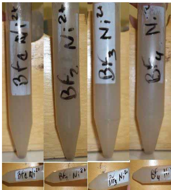
Figura 59: Estudo da formação hidrogel para bentonita leve purificada com Ni 2+ , proporções argila/ PVA (BF1 (9:1) (BF2 (8:2); (BF3 (7:3)) (BF4 (6:4))
