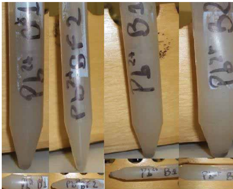
Figura 55: Estudo da formação hidrogel para bentonita não fracionada e fracionada com Pb^{2+} , proporções argila/ PVA (B1 (9:1) (B2 (8:2); (BF1 (9:1)) (BF2 (8:2))
