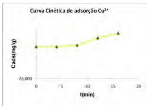
Figura 51: Cinética de adsorção do catione metálico Cu^{2+} em bentonita leve e purificada, T=24\pm 1 °C, 1 atm.
