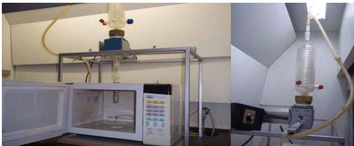
Figura 8: Adaptação do micro-ondas doméstico com inserção de um sistema rotativo.
