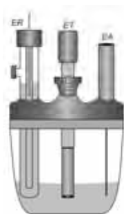
Figura 5. Esquema de uma célula eletroquímica contendo três eletrodos.
