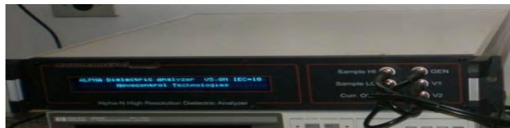
Figura 25. Fotografia do equipamento Novocontrol modelo Alpha-N High Resolution Dielectric Analyser (Alemanha) utilizado para as medidas de impedância.
