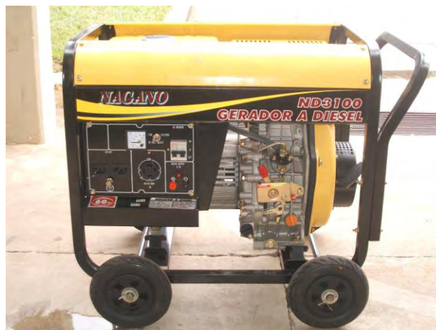
Figura 28. Motor gerador a diesel NAGANO 178f.
