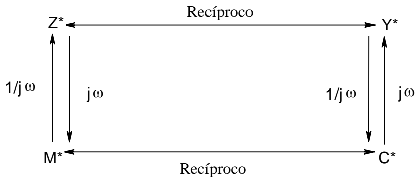
Figura 23. Representação esquemática da seqüência matemática dos formalismos correlacionados com a impedância, onde Z^* representa a impedância complexa, Y^* a admitância, C^* a capacitância e M^* o módulo elétrico.
