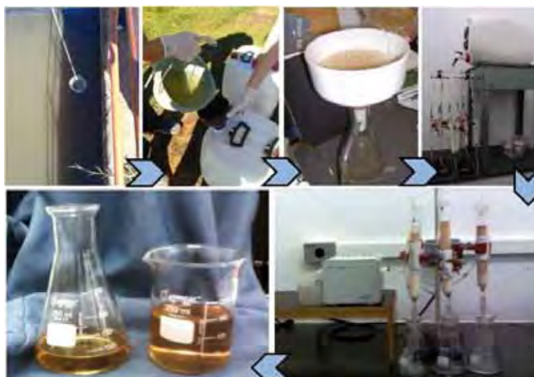
Figura 3. Esquema de extração das SHA do Rio Preto, passando pela coleta, filtração, percolação nas colunas, eluição e finalmente obtenção das mesmas.
