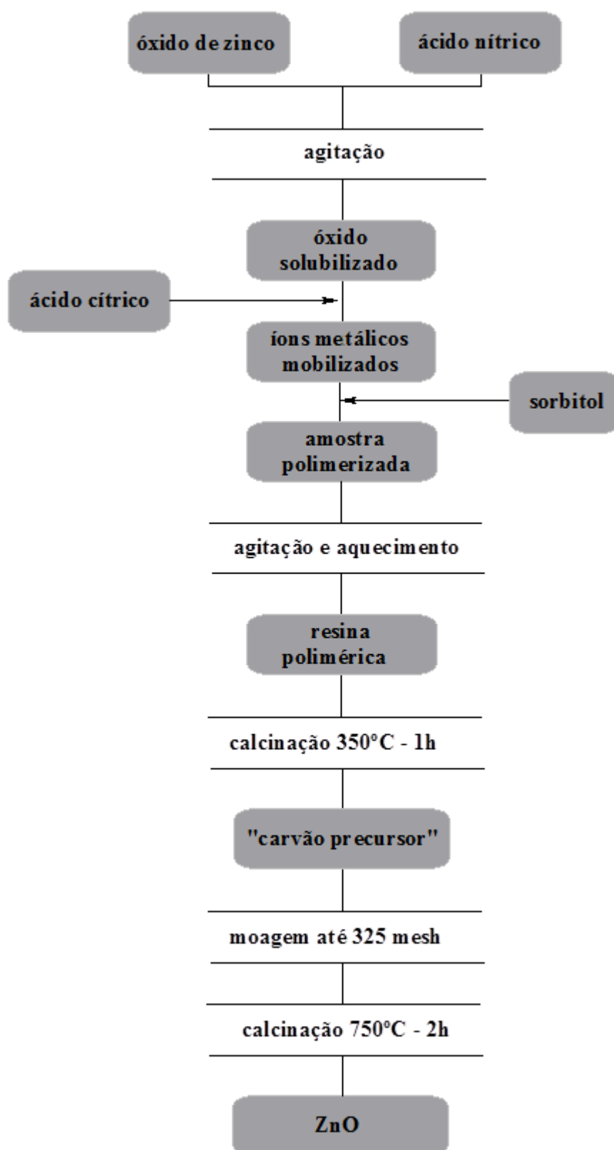
Figura 7 - Fluxograma representativo da preparação dos óxidos de zinco a partir do método Pechini modificado.
