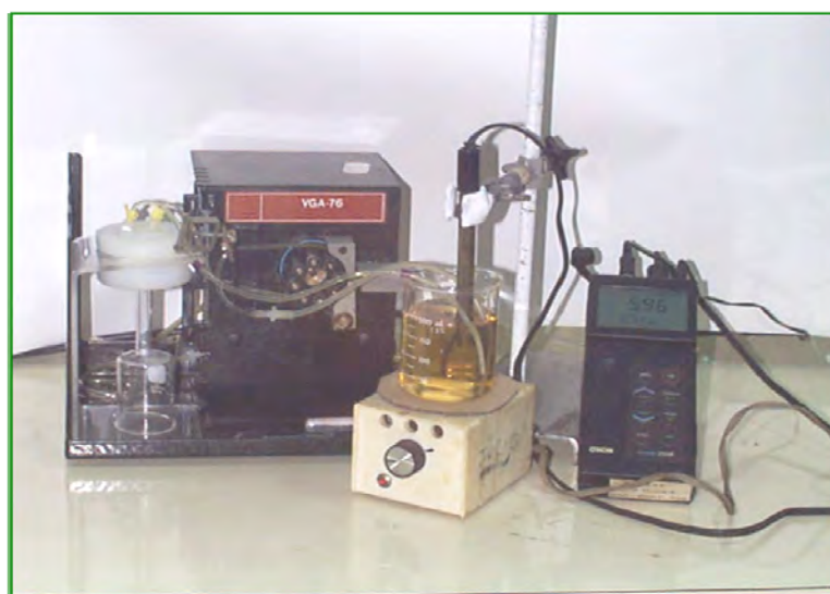
Figura 14: Sistema de ultrafiltração utilizado para estudo de complexação entre as SH e espécies metálicas.
