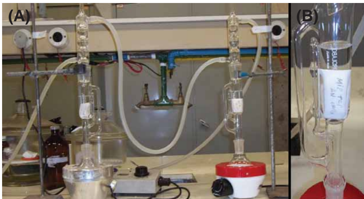
Figura 18: Aparelhagem para lavagem dos polímeros. (A) NIP à esquerda e MIP à direita no processo lavagem através do refluxo por Soxhlet. (B) detalhe de como o sólido é armazenado no processo na forma de cartuchos preparados com papel de filtro.
