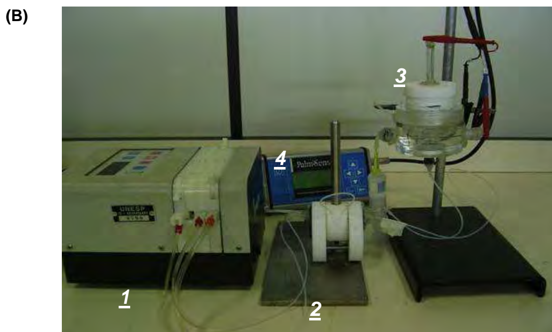
Figura 9: Representação esquemática do sistema de injeção em fluxo (FIA) em (A) e a fotografia do sistema em (B): (1) Bomba peristáltica, (2) Injetor, (3) Cela Eletroquímica, (4) Potenciostato.
