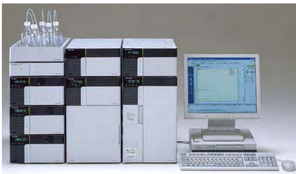
Figura 10: Equipamento de cromatografia líquida de alta eficiência da marca Shimadzu® utilizado nas análises das amostras de captopril.
