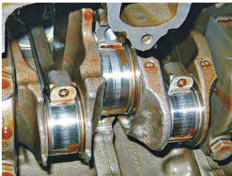
Figura 2: Ranhuras nos colos do virabrequim causadas por lubrificação deficiente. (Fonte: < http://quatorrodas.abril.com.br/imagem/rep_281009_motorvw_1.jpg >. Acesso em: 17 nov. 2010.)
