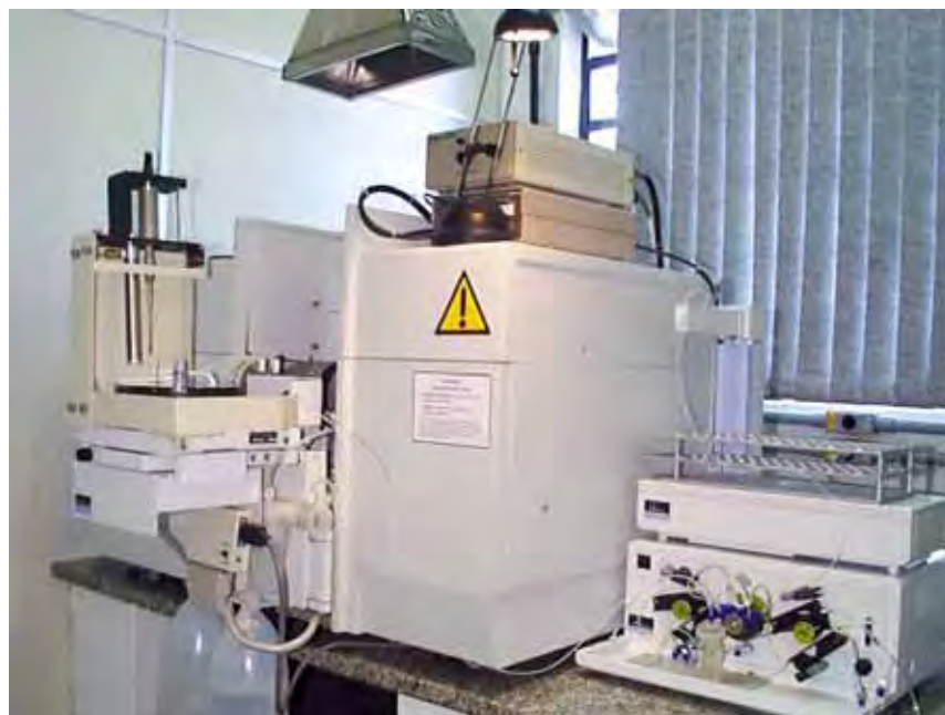
Figura 5. Espectrômetro de absorção atômica Perkin Elmer SIMAA 6000.
