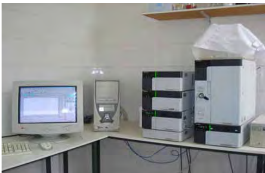
Figura 11: Visão geral do aparelho de HPLC utilizado na quantificação dos antibióticos.
