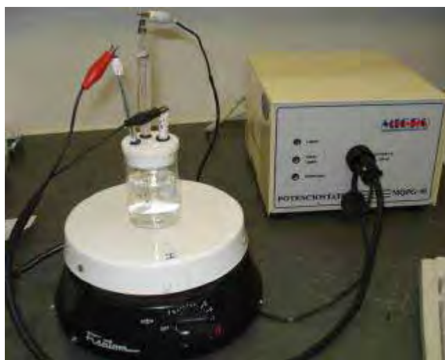
Figura 18- Sistema eletroquímico utilizado.
