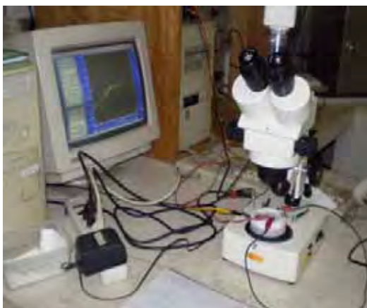
Figura 44. Imagens da célula eletroquímica de teflon acoplada a um estereomicroscópio ligada ao equipamento galvanostato / potenciostato da QUIMIS.
