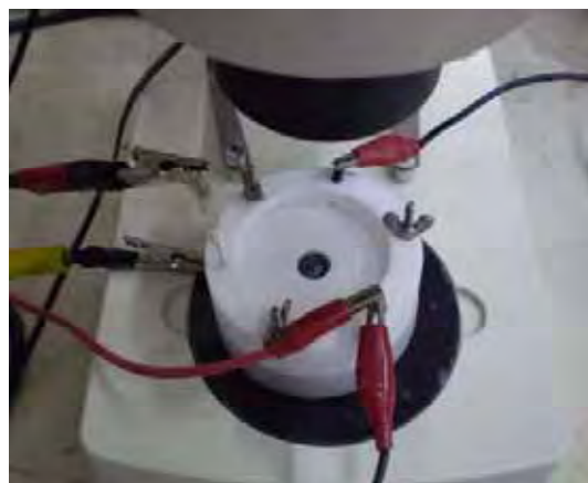
Figura 44. Imagens da célula eletroquímica de teflon acoplada a um estereomicroscópio ligada ao equipamento galvanostato / potenciostato da QUIMIS.
