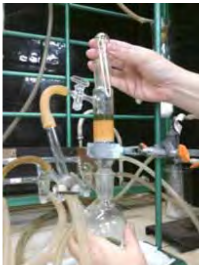
Figura 10. (a) Filtração em atmosfera de nitrogênio; (b) composto selado a vácuo em ampola de vidro.
