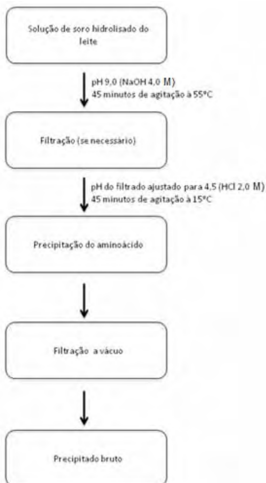
Figura 8. Fluxograma ilustrativo do procedimento de precipitação do hidrolisado a partir de hidrolisado de soro de leite bovino.
