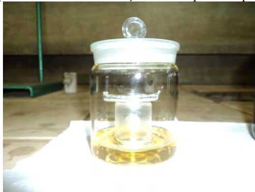
Figura 25. Aparato utilizado na obtenção dos compostos expostos à amônia.
