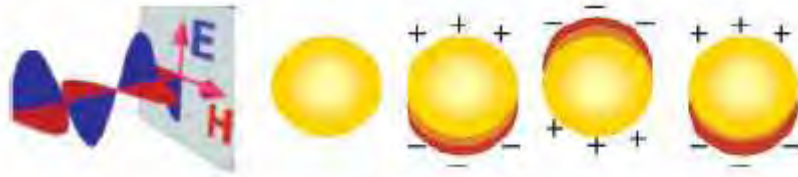
Figura 7– Esquema da interação de radiação eletromagnética com uma nanoesfera metálica. Um dipolo é induzido, que oscila em fase com o campo elétrico da luz incidente 18 .
