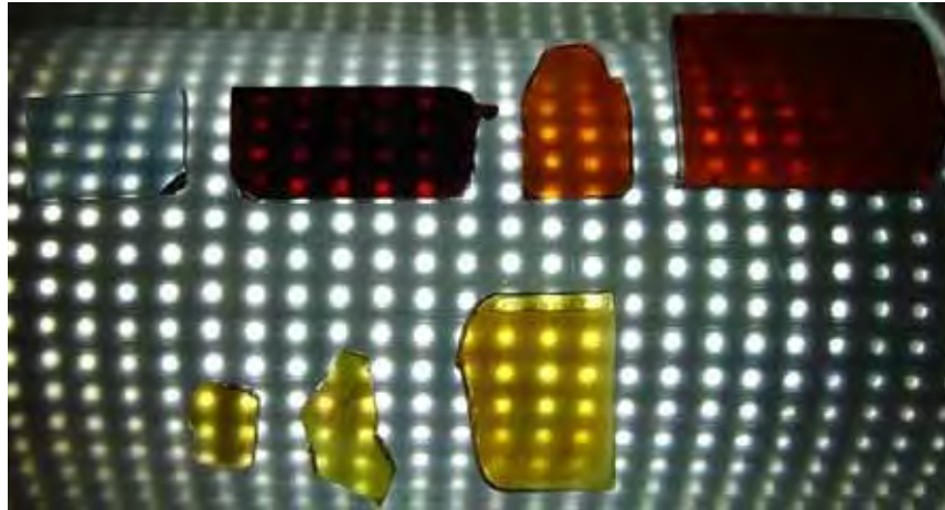
Figura 12 – Vidros preparados neste trabalho. Acima: 0Ag, 5Ag, 7,5Ag, 10Ag. Abaixo: 12,5Ag, 15Ag, 20Ag.
