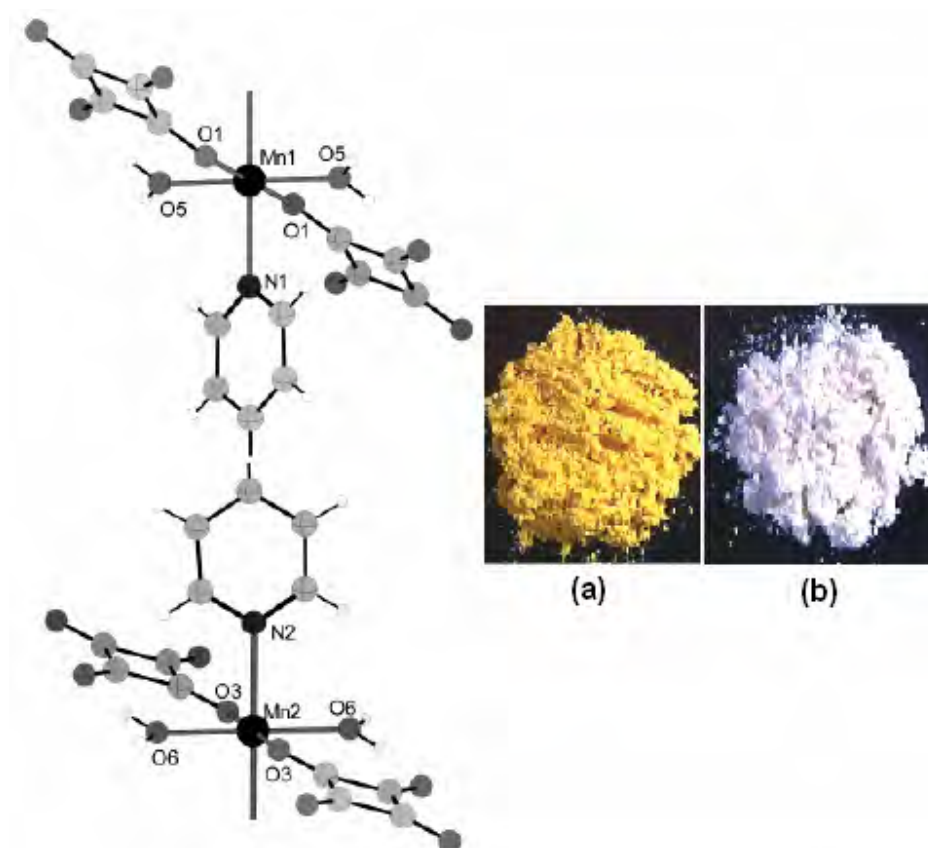
Figura 14. Estrutura cristalina do poli[diáquo( \mu_2 -esquarato- O,O' )( \mu_2 -4,4'-bipiridina- N,N' )manganês(II)] trihidratado: (a) amostra na qual a água foi removida completamente; (b) após armazenagem da amostra em atmosfera saturada de ar [38].
