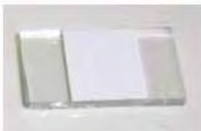
Figura 13. Vidro condutor contendo a pasta de \text{TiO}_2 .
