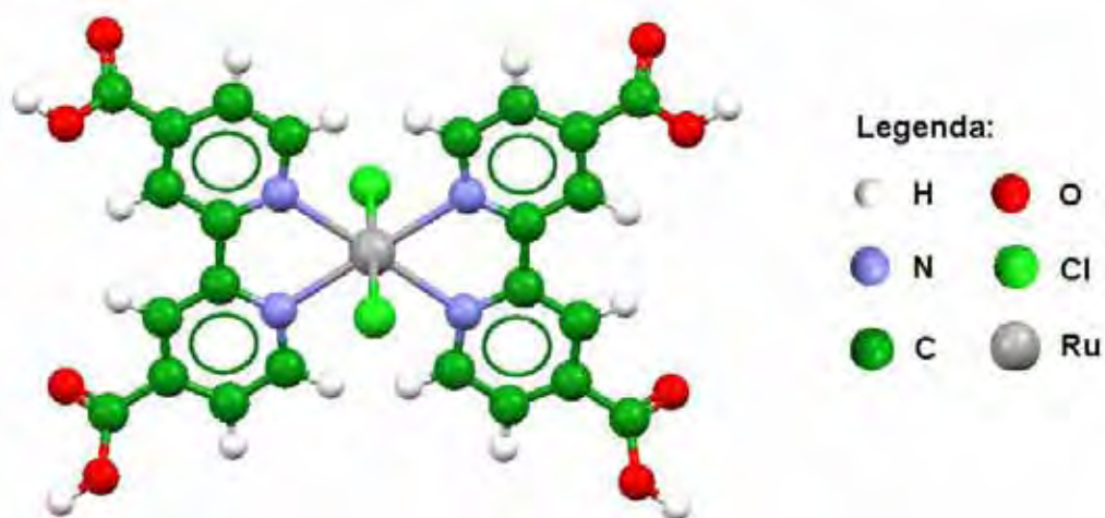
Figura 69. Estrutura do composto [\text{RuCl}_2(\text{dcbpy})_2] (D1).
