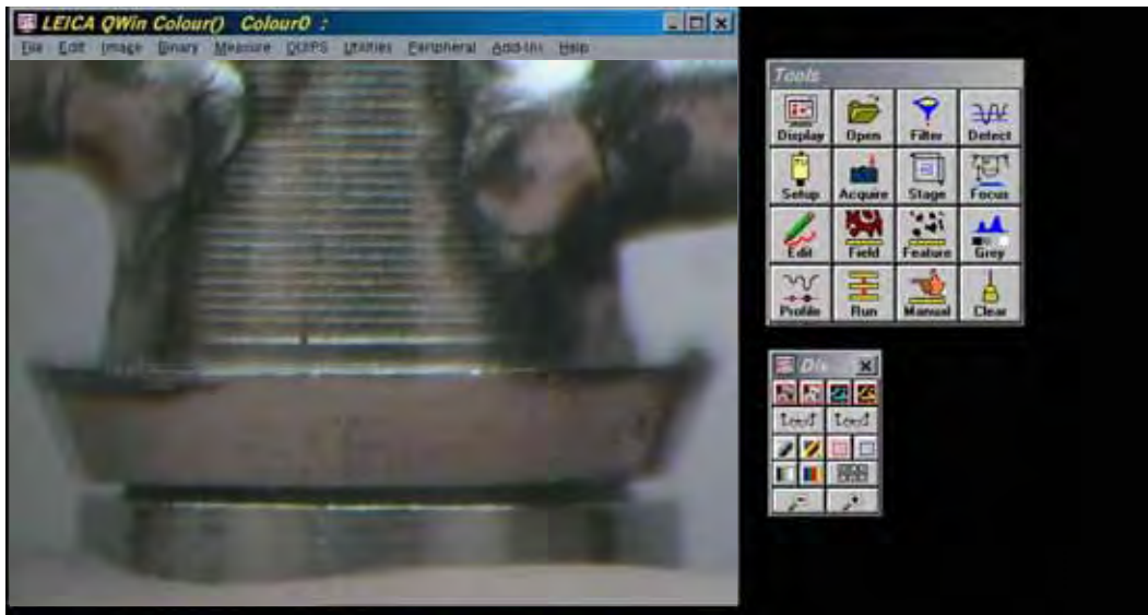
FIGURA 44 – CENTRALIZAÇÃO DA ESTRUTURA METÁLICA COM AUMENTO DE 16 VEZES DO ANÁLOGO B NO 1º MODELO DA TÉCNICA CÔNICO / EXPRESS.
