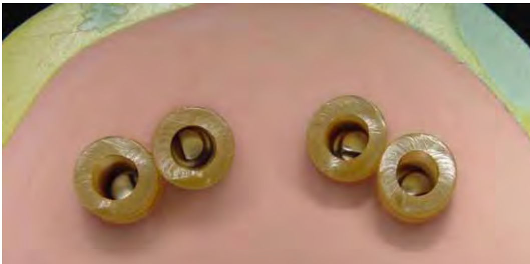
FIGURA 32– INÍCIO DA PRESA DO GESSO.
