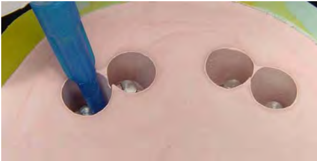
FIGURA 36 – MÉTODO EMPREGADO PARA INJETAR O GESSO NO INTERIOR DOS ESPAÇOS CRIADOS.
