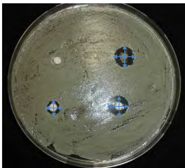
FIGURA 6 – Zonas de inibição microbiana ao redor dos corpos-de-prova.
