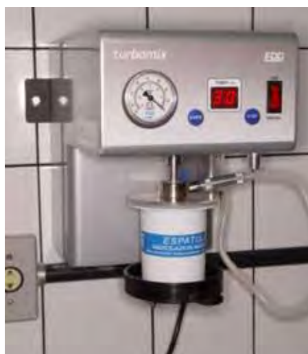
FIGURA 2 - Cuba metálica posicionada no espatulador mecânico e pronta para o início da espatulação.
