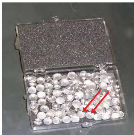
FIGURA 16- Dispositivos onde as amostras são colocadas para a realização do teste.
