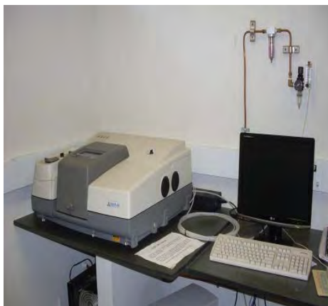
FIGURA 7 - Equipamento Nexus 6700 acoplado a computador para registro digital das análises.
