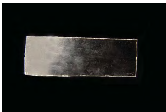
FIGURA 6 - Espécime obtido após desinclusão e acabamento.
