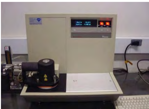
FIGURA 19 - Forno do DSC fechado e iniciado fluxo de calor sobre as amostras.
