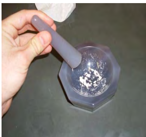
FIGURA 8 - KBr + amostra sendo macerados.
