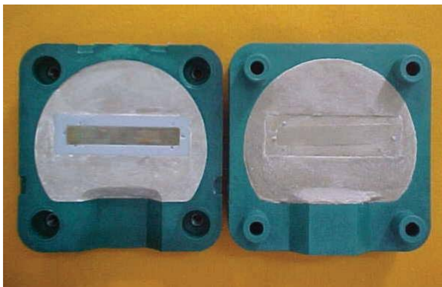
FIGURA 23 - Conjunto silicone/ padrão metálico incluído em mufla plástica.
