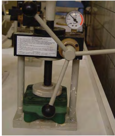
FIGURA 4 - Mufla mantida sob a prensa por 30 minutos.
