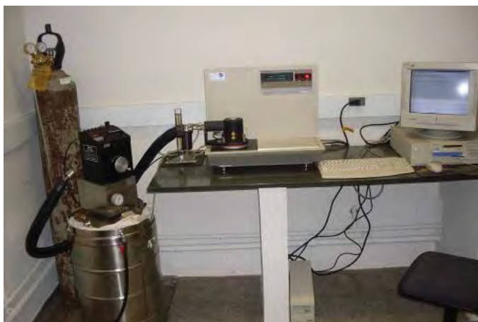
FIGURA 15 - Equipamento para Análise Térmica Via Calorimetria Diferencial de Varredura (DSC).
