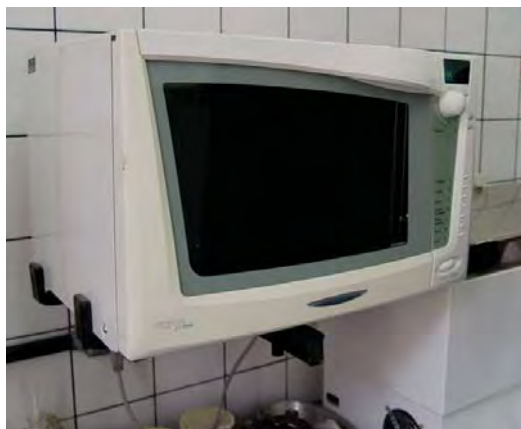
FIGURA 5 - Forno de micro-ondas da marca Continental utilizado para polimerização da resina acrílica.
