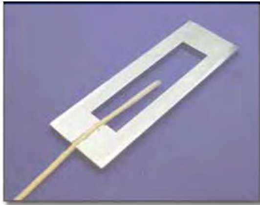
FIGURA 9 – Sensor de fibra óptica em posição na matriz metálica vazada.
