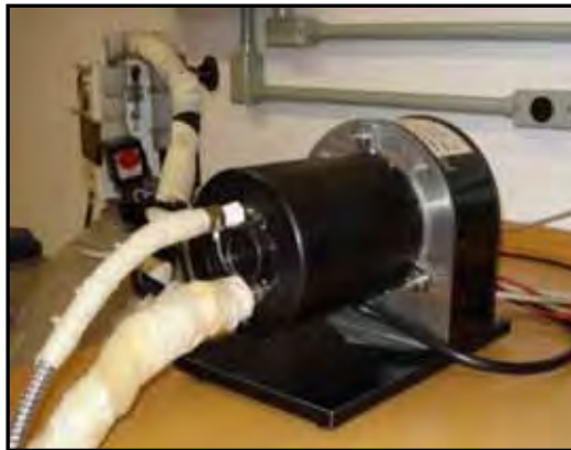
FIGURA 14 – Forno acoplado a máquina de ensaios de DMTA.
