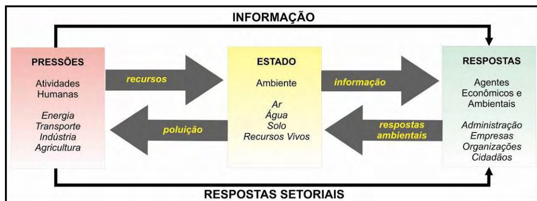
Figura 3.1.: Modelo Pressão-Estado-Resposta da OECD. Fonte: Lira e Cândido (2008).
