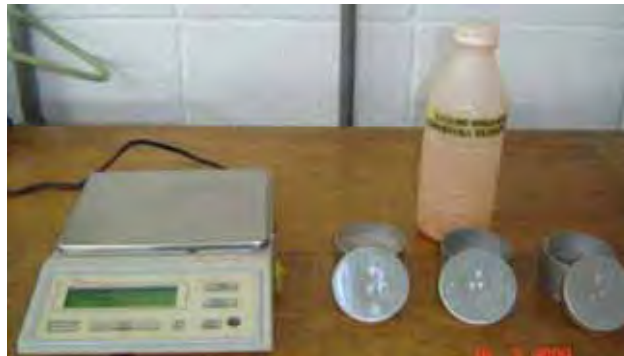
FIGURA 19 - Utensílios empregados na determinação da massa dos sedimentos em suspensão
