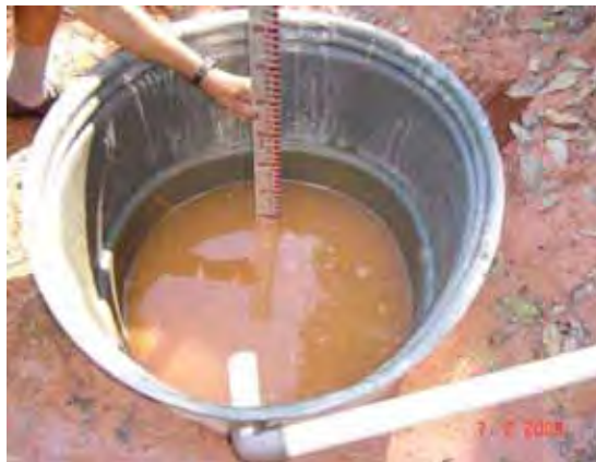
FIGURA 18 – Processo de medição indireta do volume de água escoado
