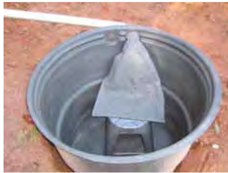
FIGURA 9- Tanque com a bolsa de geotêxtil
