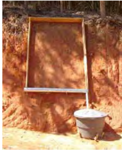
FIGURA 16 - Método superfície de controle, instalado no talude 2.
