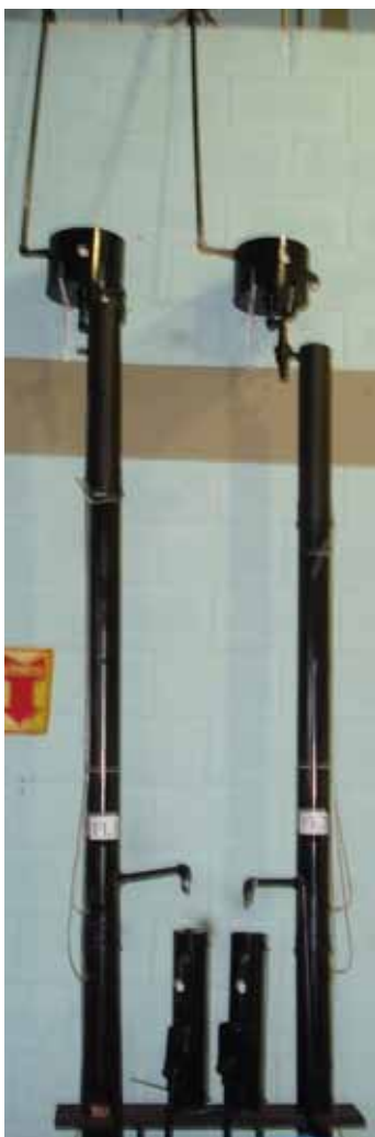
Figura 9: Filtros lentos utilizados na pesquisa
