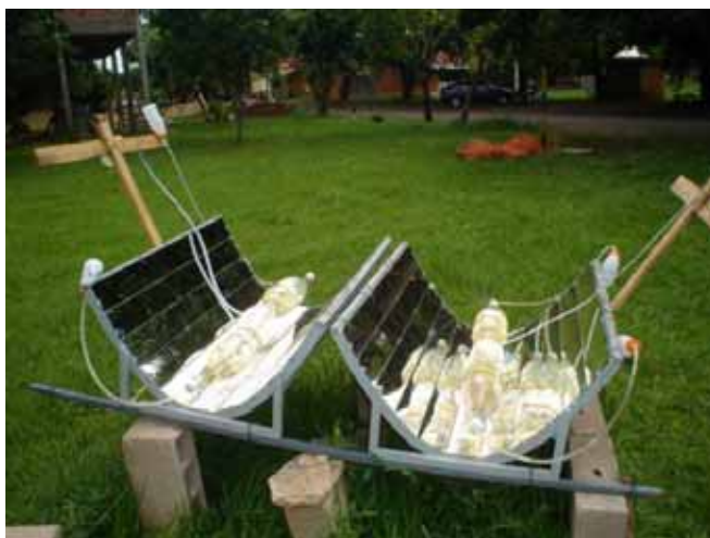
Figura 13: Vista geral dos concentradores parabólicos
