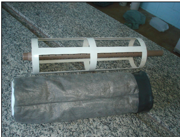
Figura 4.14 – Coluna vertical de filtração e manta não-tecida.
