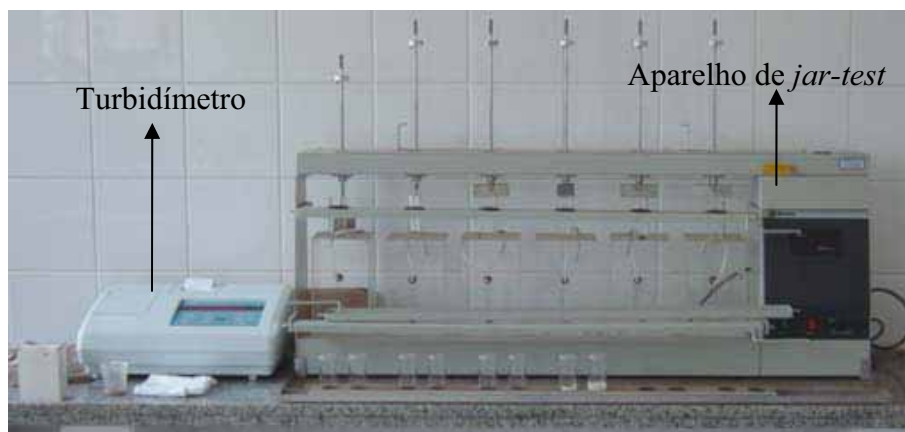
Figura 21: Equipamentos utilizados na realização dos ensaios em jar-test
