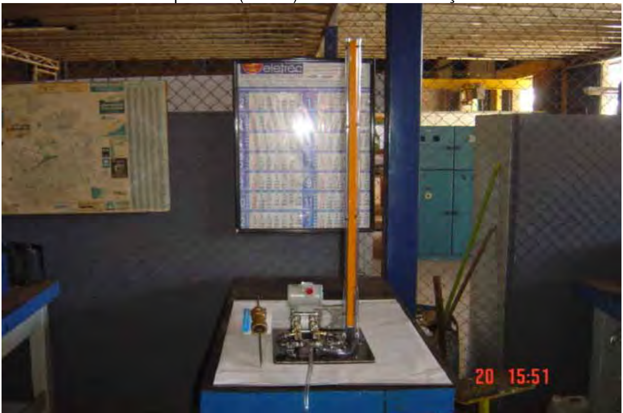
Uma vista geral do dispositivo para calibração do transdutor de pressão diferencial.
