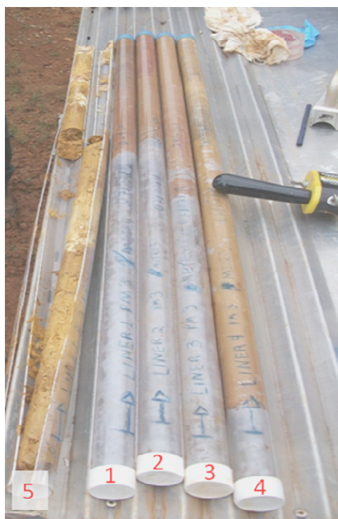
Figura 21: Variações visuais na coloração e composição do solo do aterro. Liners retirados à cada 1,20 m de profundidade. 1) solo superficial; 4) solo próximo ao fundo das valas; 5) solo amarelado, com concreções (após 5m).
