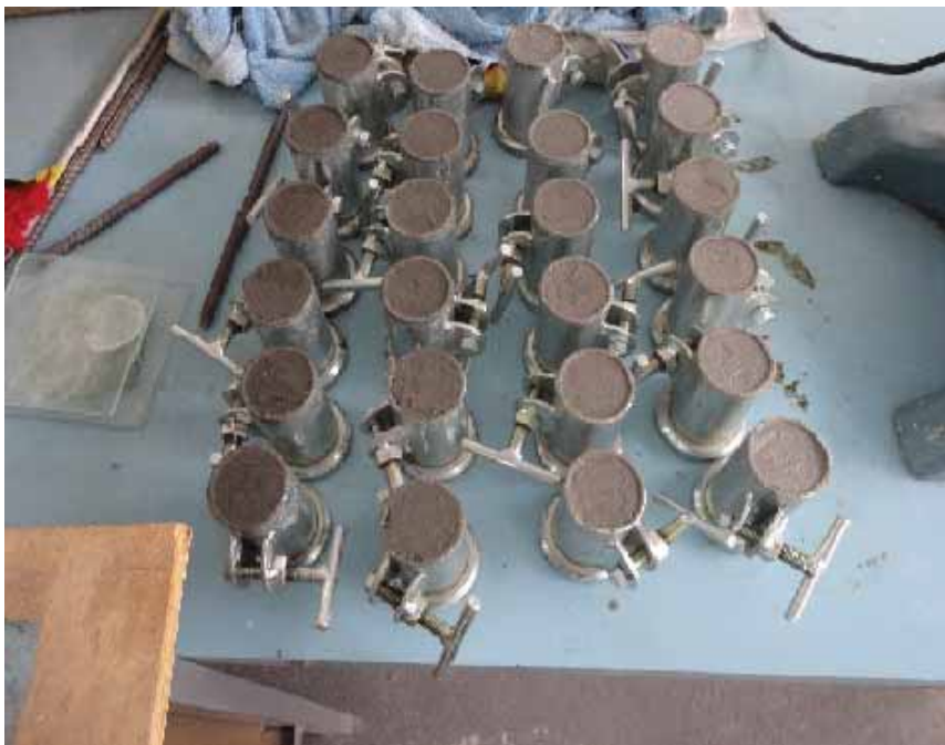
Figura 11 - Traços da argamassa após o processo de adensamento nos moldes.
