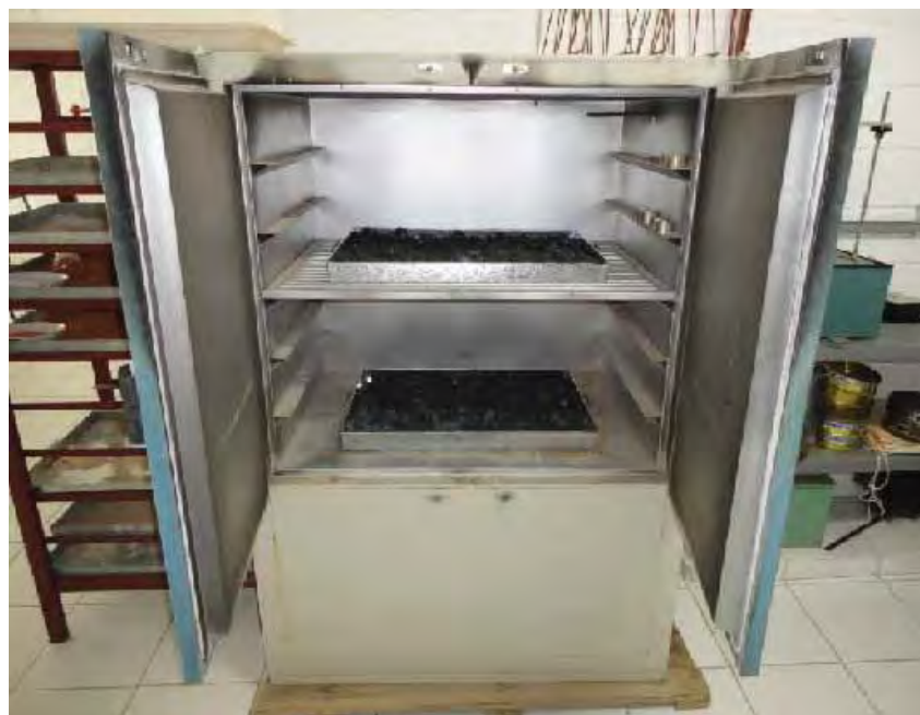
Figura 7 - Secagem do composto dregs-grits em estufa a 105^{\circ}\text{C} \pm 5^{\circ}\text{C} por 24 horas.
