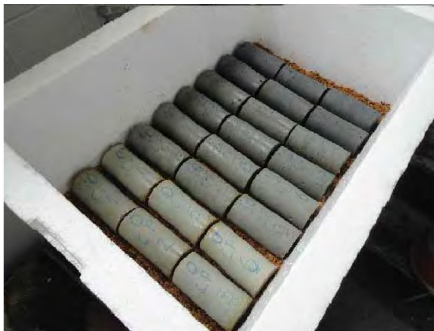
Figura 12 - Corpos de prova (5 cm de diâmetro por 10 cm de altura) acondicionados em caixa de isopor com serragem úmida para ensaio de resistência à compressão aos 28 dias de cura.
