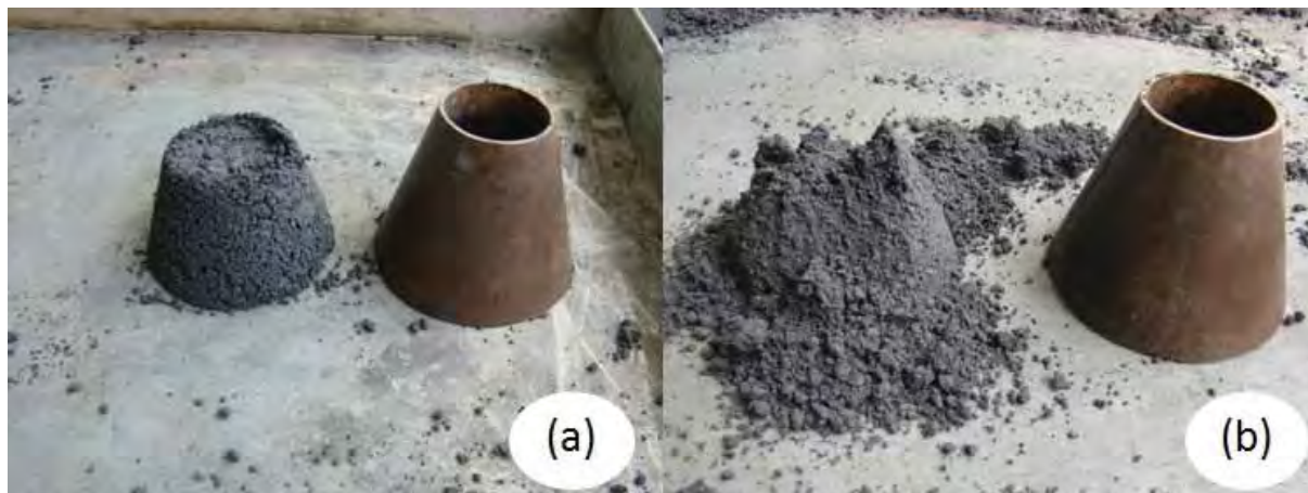
Figura 10 - Preparação da amostra segundo NBR NM 52/2002: Partículas fortemente aderidas entre si, após 25 golpes e remoção do tronco-cone (metálico, de 4 cm de diâmetro superior, 9 cm de diâmetro inferior e 7,5 cm de altura) (a); Partículas saturadas e superfície seca prontas para a realização do ensaio, após 25 golpes e remoção do tronco-cone (b).
