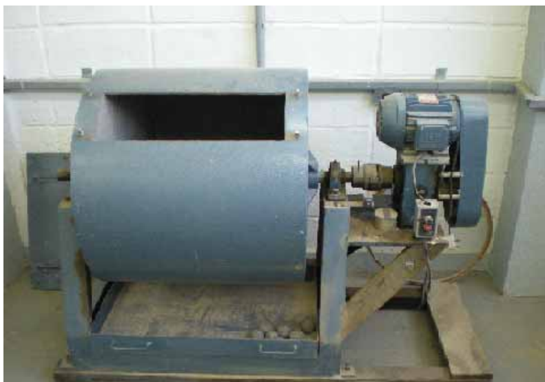
Figura 8 - Moagem do composto dregs-grits em moinho de bolas, conforme NBR NM 51/2001.
