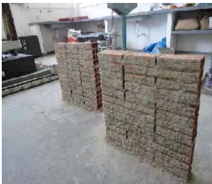
Figura 15 - Paredes chapiscadas após 26 dias de cura.
