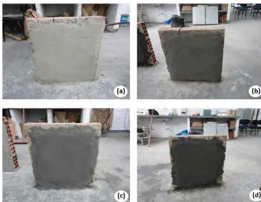
Figura 16 - Argamassa mista de revestimento aplicada sobre as paredes chapiscadas: (a) traço padrão, sem adição do composto dregs-grits – 0%, (b) traço contendo composto dregs-grits – 10%, (c) traço contendo composto dregs-grits – 20%, e (d) traço contendo composto dregs-grits – 30%.
