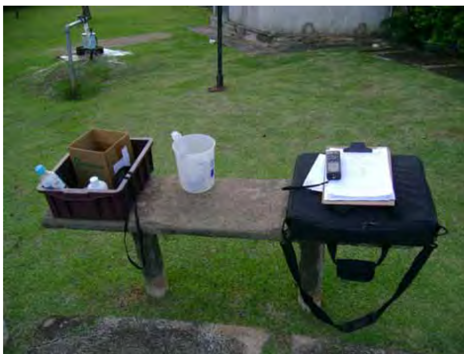
Figura 4 - Aguardando escoamento da água estagnada no cano para a realização da coleta, detalhe do poço sem a proteção sanitária.
