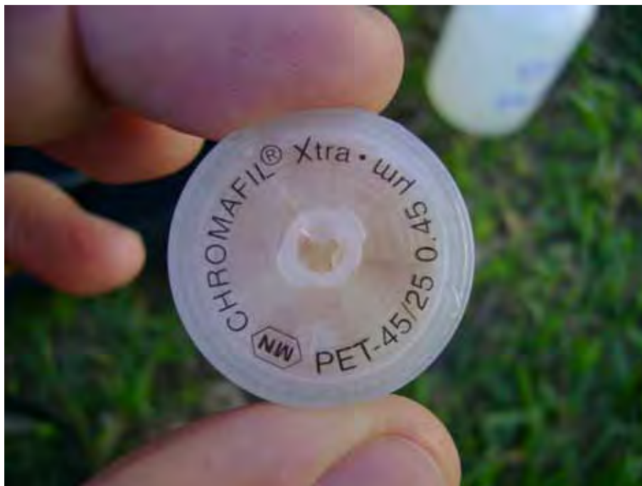
Figura 11 - Filtro do Poço 15, detalhe a retenção de STS no filtro.
