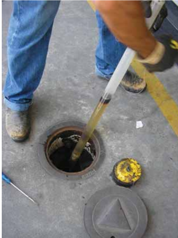
Figura 29 – Coleta de amostra de água subterrânea com o amostrador bailer (Construfer, 2008).
