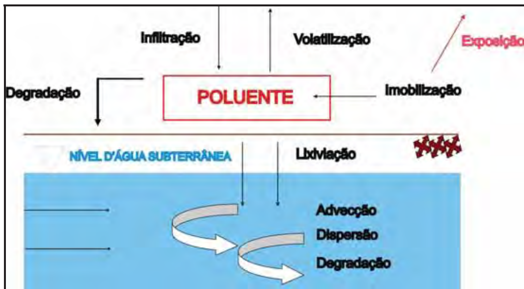
Figura 7 - Transporte de hidrocarbonetos e processos que influenciam o seu destino no solo (Adaptado de Santos, 1998).
