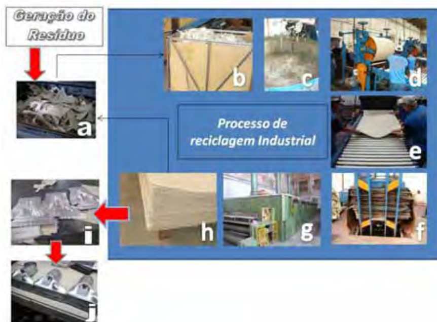
Figura 6: Esquema representativo do processo de reciclagem de isolantes térmicos em escala industrial. Em (a) a representação de aparas de resíduos de isolante térmico, em (b) a embalagem de envio dos resíduos para industrialização, (c) o hidrapulper , (d) máquina desfolhadeira responsável pela formação das folhas, (e) retirada das folhas da máquina, (f) prensagem para a retirada do excesso de água, (g) secagem
