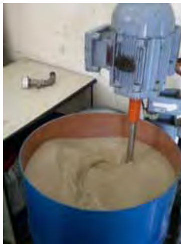
Figura 4: Pulper adaptado de um motor WEG de 15cv.
