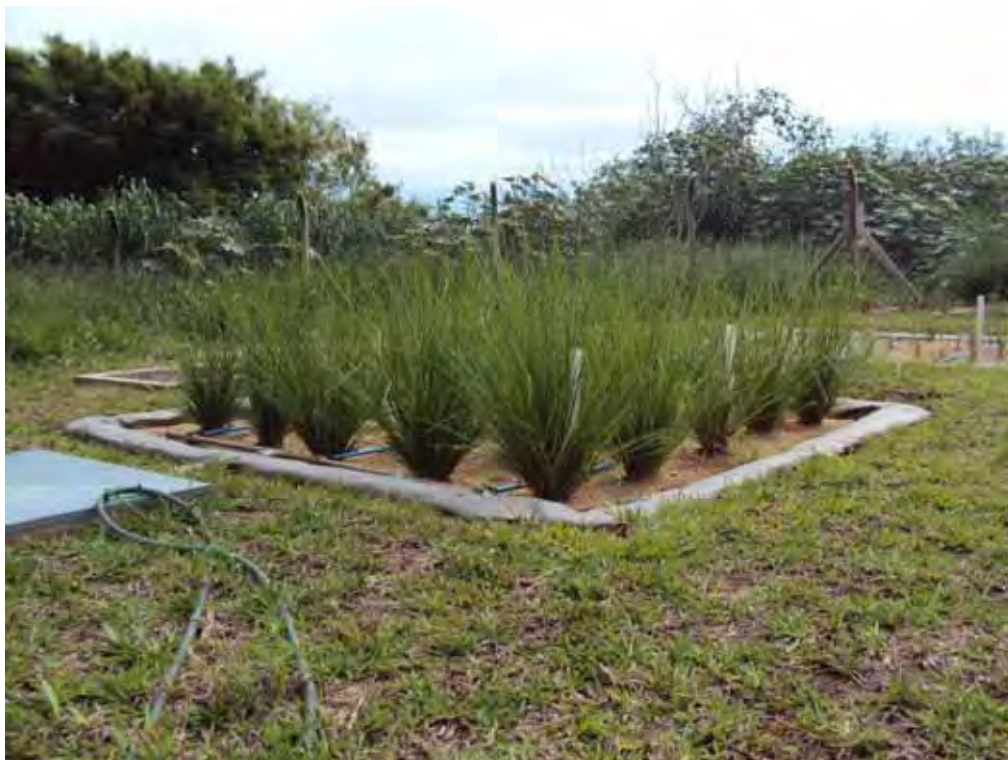
Figura 14: Tanque 2V, preenchido com poliestireno expandido e areia na camada superficial (Foto: Larissa Miranda-Santos)
