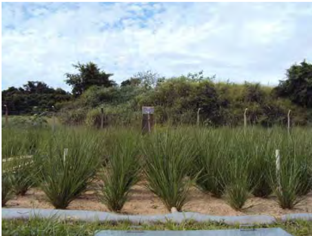
Figura 11: Tanque 2H, preenchido com poliestireno expandido moído e areia na área superficial (Foto: Larissa Miranda-Santos)
