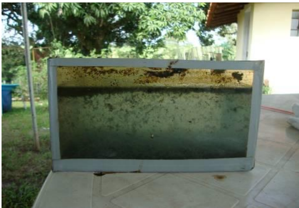
Figura 22: Flocos suspensos a pós a remoção da espuma
