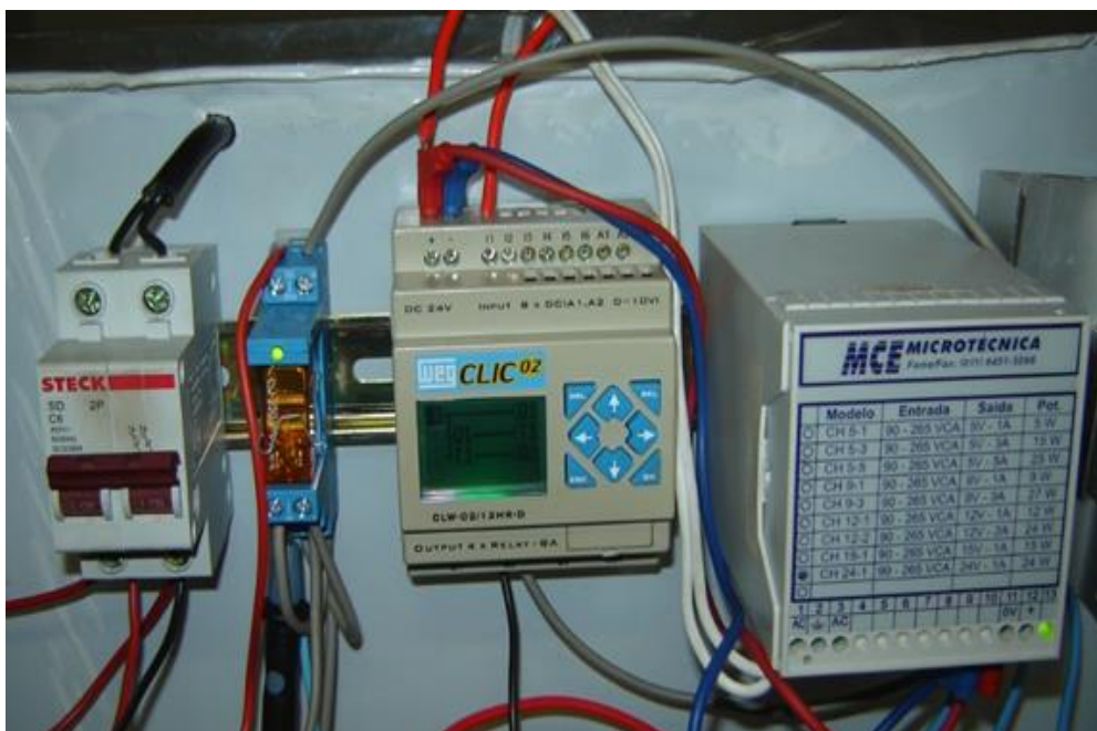
Figura 25: Foto do CLP e do relé com dois contatos reversíveis
