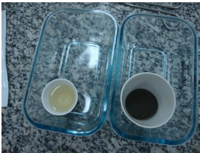
Figura 18: Efluente e filtro pós-filtragem para obtenção de dados de sólidos totais
