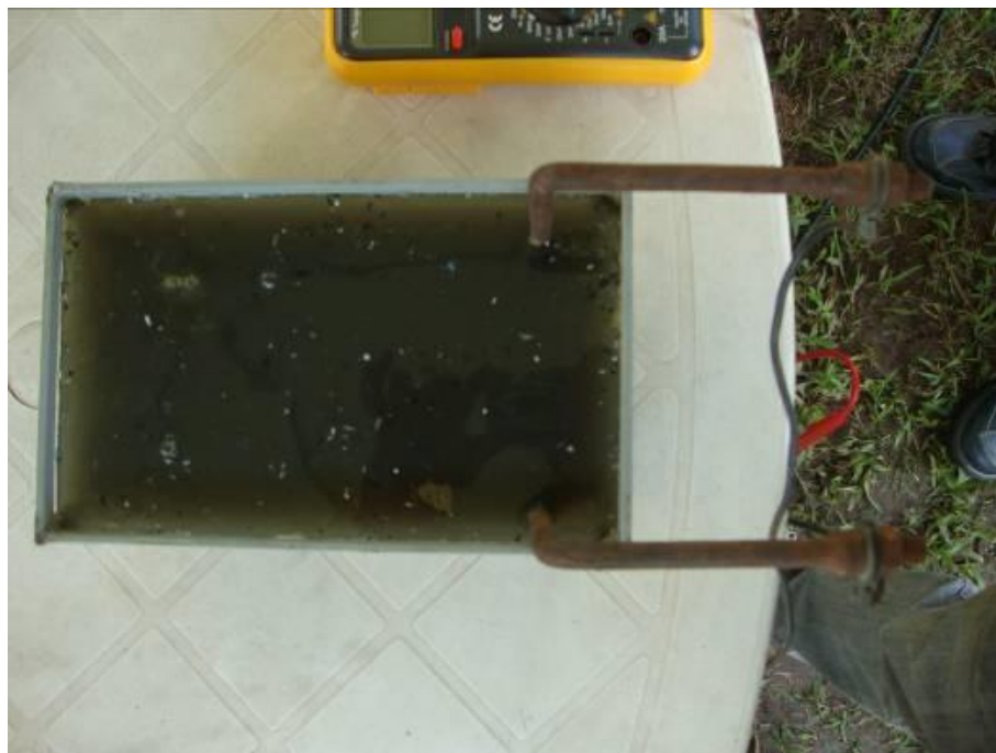
Figura 20: Célula eletrolítica com efluente antes da eletrólise: (a) vista frontal e (b) vista superior
