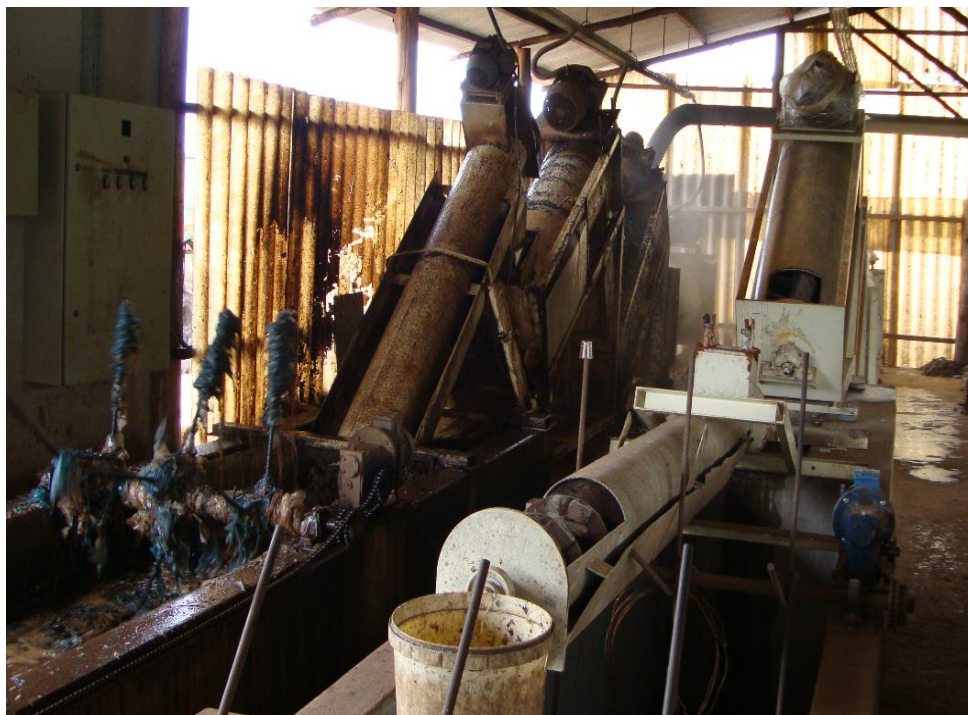
Figura 14: Tubo de eixo rotativo que separa os materiais flutuantes (de interesse) da água
