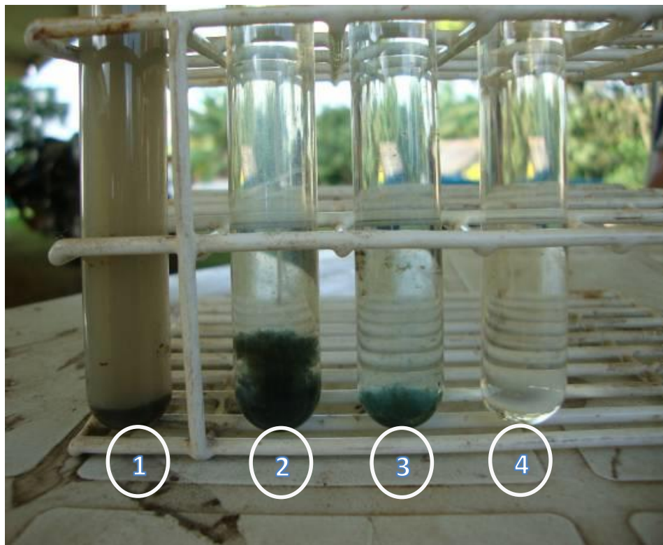
Figura 29: Amostras dos efluentes coletados durante o tratamento com sistema eletrolítico, sendo: 1 - Efluente bruto inicial; 2 - Efluente após 10 minutos de tratamento; 3- Após 20 minutos e 4 - Após 30 minutos
