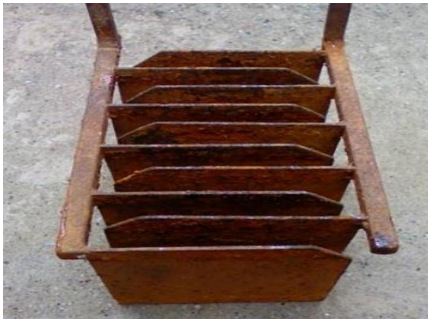
Figura 19: Eletrodos em ferro fundido utilizados na célula eletrolítica
