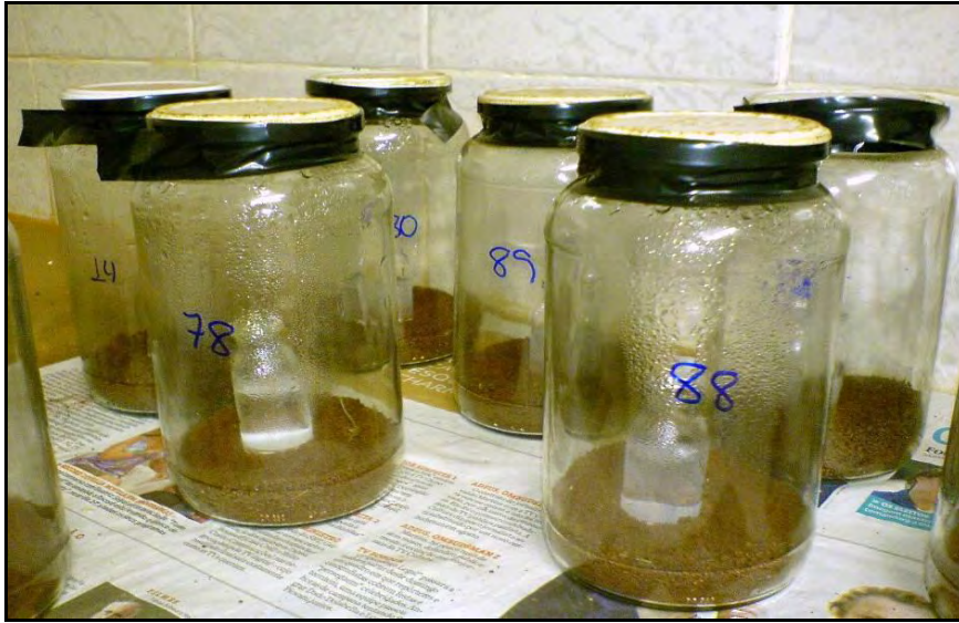
FIGURA 7. Implantação do ensaio para quantificação do carbono do \text{CO}_2 (C- \text{CO}_2 ) liberado no Laboratório de Microbiologia do Departamento de Fitossanidade Engenharia Rural e Solo da UNESP – Universidade Estadual Paulista, Faculdade de Engenharia, Campus de Ilha Solteira.
