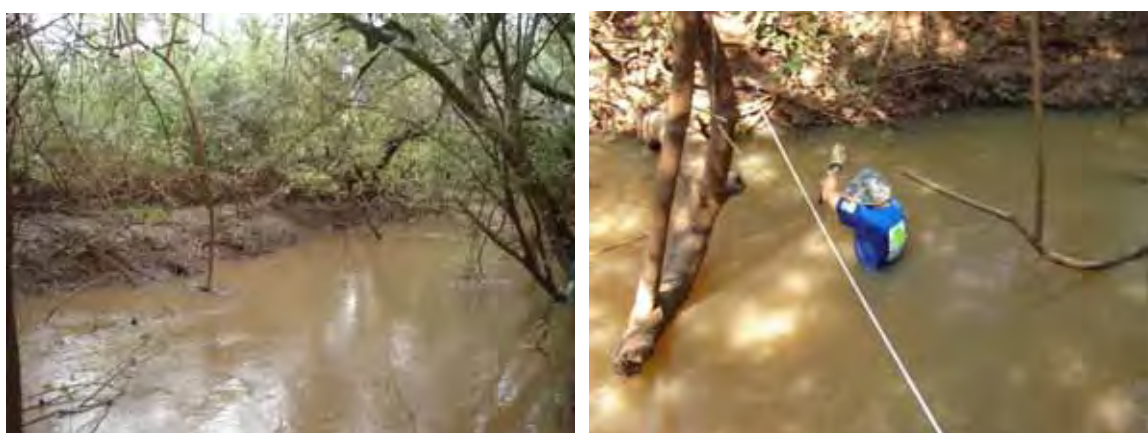
Figura 13. Ponto 5 de amostragem coleta da água e medição da vazão.
