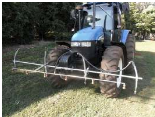
Figura 5. Visão frontal do equipamento, em detalhe, com a barra de pulverização acoplada ao trator para pulverização de inseticida em área total.
