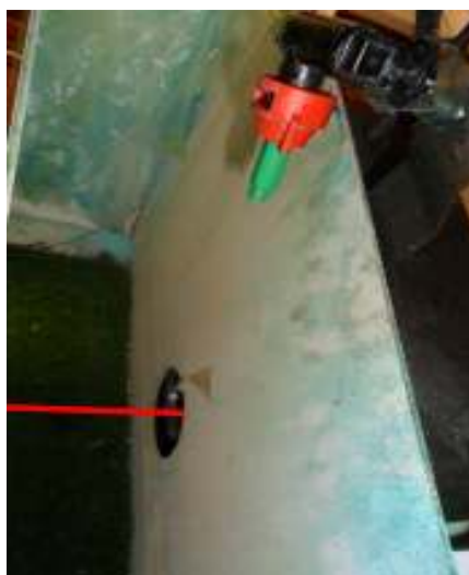
Figura 6. Detalhe do posicionamento do bico em relação ao feixe do laser (simulação).
