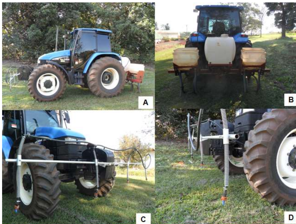
Figura 4. Visão geral do equipamento utilizado para a aplicação localizada de inseticida em operação conjugada a fertilização. A: Visão lateral do conjunto trator-pulverizador. B: Compartimentos laterais para fertilizantes e ao centro o reservatório de calda. C e D: Barra de pulverização desenvolvida para a aplicação localizada de inseticida em milho.
