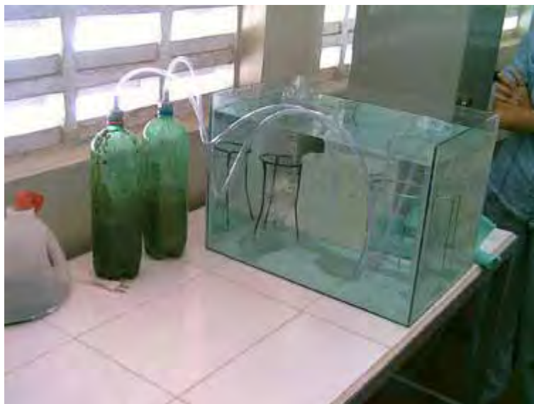
Figura 3.7 – Biodigestor experimental construído pelos alunos de Caçapava.
