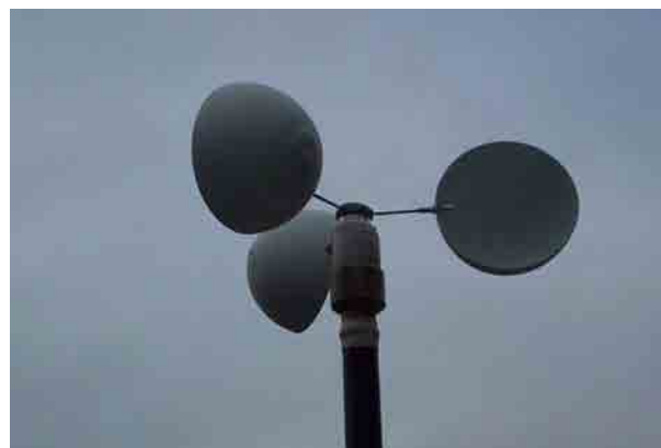
Figura 19 Anemômetro de copos experimental.
