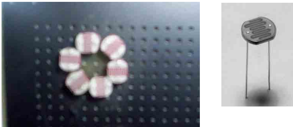
Figura 17 Painel com fotoresistores em série
