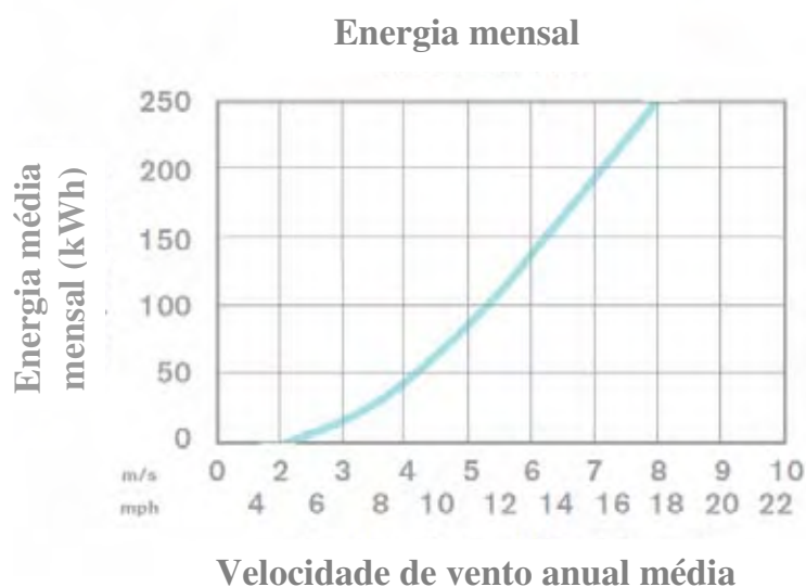
Figura 46 – Energia mensal em relação à velocidade de vento incidente (SOUTHWEST Wind Power, 2012)
