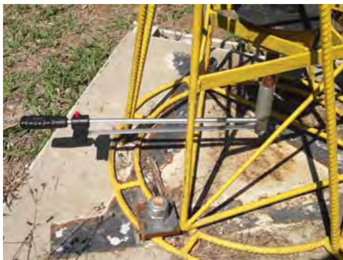
Figura 40 – Posicionamento do torquímetro no eixo do aeromotor
