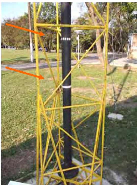
Figura 34 – Pontos de medição de rotações por minuto no eixo do aeromotor
