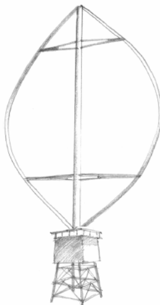
Figura 7 – Aeromotor de eixo vertical Darrieus (ISLAM, M., 2008)
