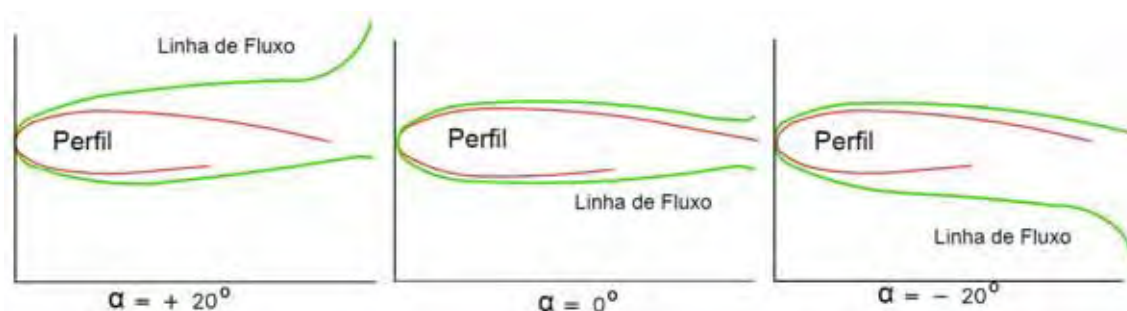
Figura 24 – Linha de fluxo no perfil NACA 0018-53 ( Re = 278266 ) ( Design Foil )
