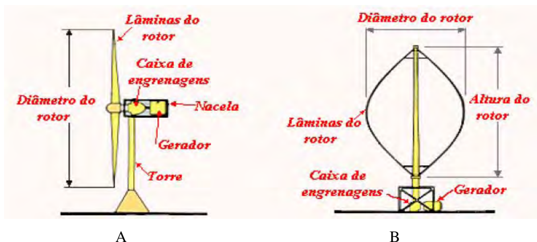
Figura 4 – Componentes de um aerogerador. A: HAWT (REIS, L. O. M., 2002), B: VAWT (REIS, L. O. M., 2002)
