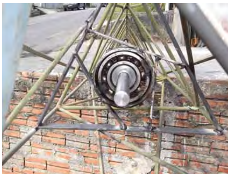
Figura 27 – Eixo de transmissão: Mancal inferior e terminal de acoplamento
