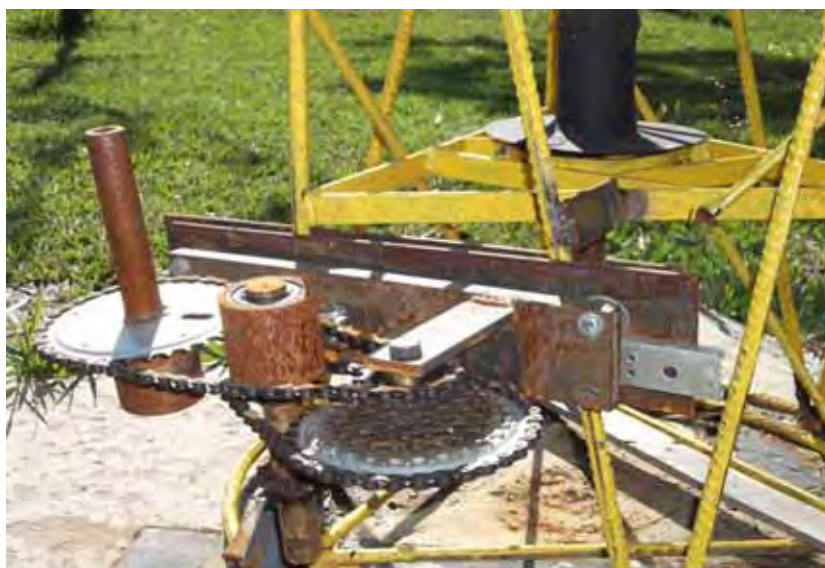
Figura 28 – Redutor de velocidades instalado no eixo do aeromotor
