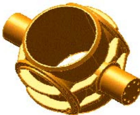
Figura 12: Obturador da Válvula Esférica (ALSTOM, 2006)
