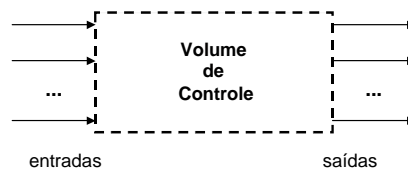
Figura 3.1 – Escoamento em regime permanente
