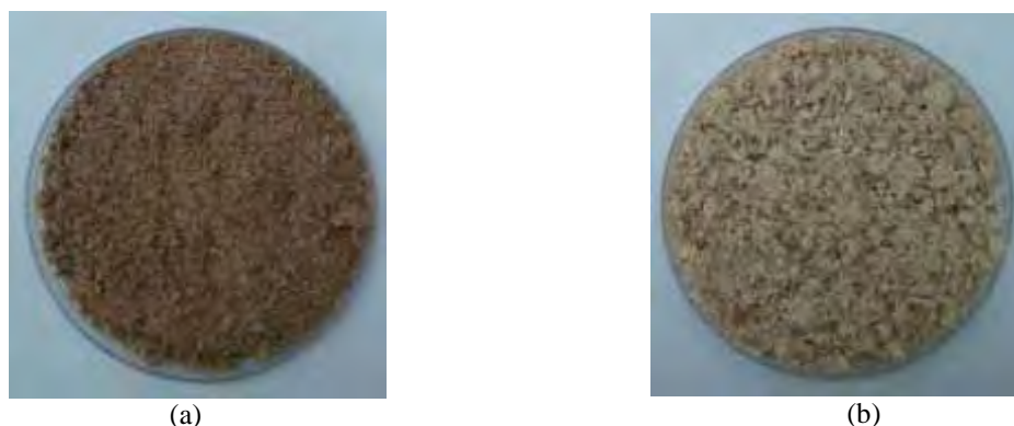
Figura 4.4 - (a) Fibras de bagaço mercerizadas (FBM); (b) Fibras de bagaço branqueadas (FBB).
