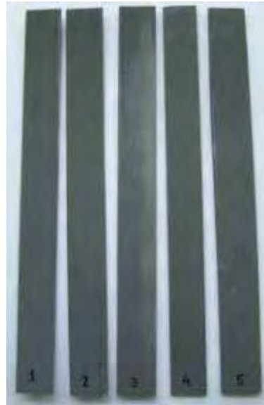
Figura 4.42 - Corpos de prova de tração segundo AST D3039 do compósito poliéster/fibra de vidro.
