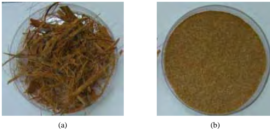
Figura 4.1 - (a) Fibras de coco após extração; (b) Fibras de coco moídas
