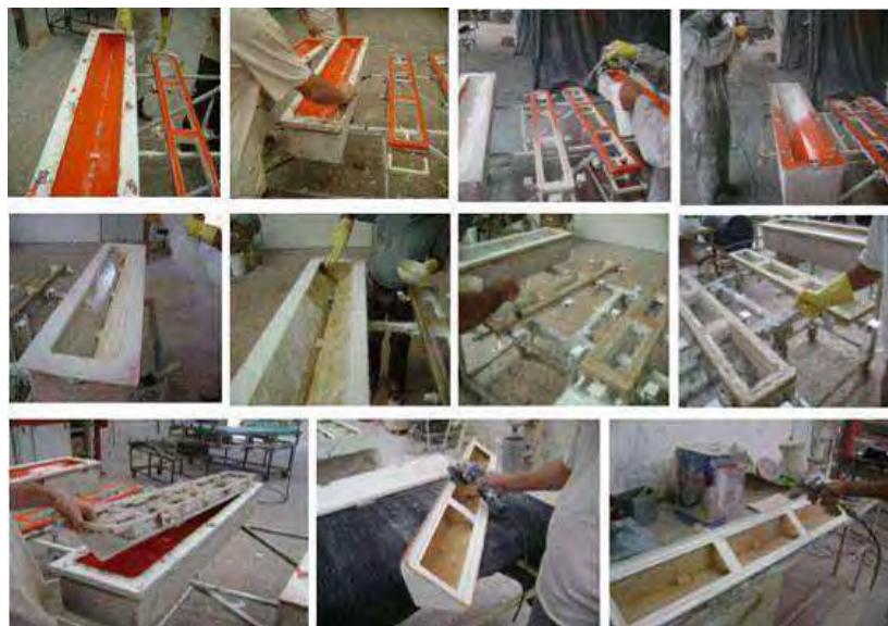
Figura 3.4 Processo de laminação para obtenção da luminária utilizada em frigorífico.
