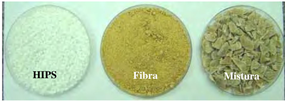
Figura 4.15 - HIPS/fibra de bagaço branqueada após o processo de mistura e granulação.
