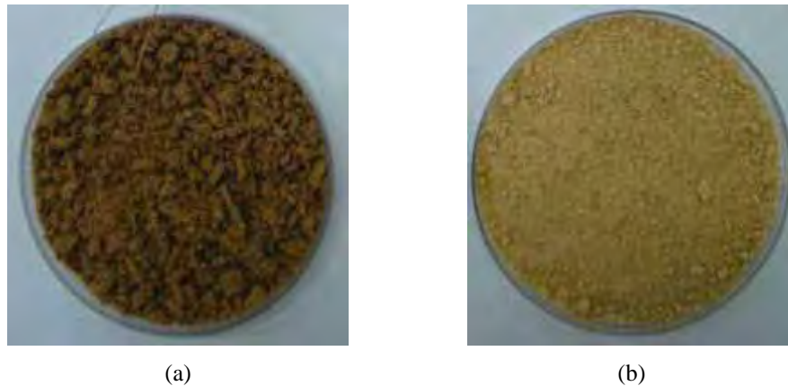
Figura 4.2 - (a) Fibras de coco mercerizadas (FCM); (b) Fibras de coco branqueadas (FCB).
