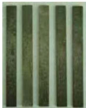
Figura 4.17 - Corpos de prova de flexão dos compósitos com 10, 20 e 30% de fibra de coco e bagaço.
