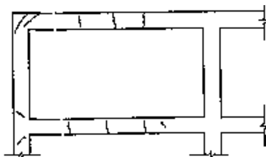
Figura 09 - Trincas em peças estruturais; a expansão da alvenaria solicita o concreto à tração.
