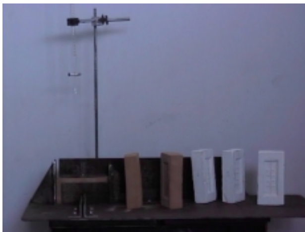
Foto 02- Aspecto da bureta de gotejamento de água, sobre a bancada de testes.
