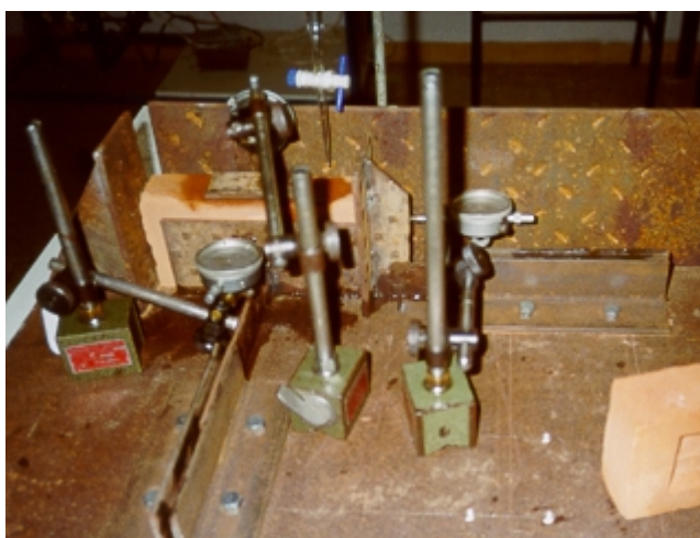
Foto 01- Confinamento do corpo de prova na bancada de testes.
