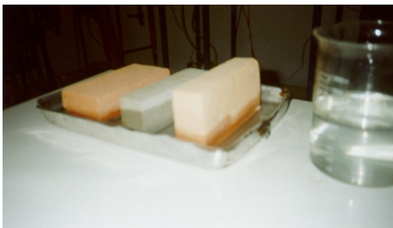
Foto 05- Visão da frente de percolação dos corpos de prova 7, 8 e 9, para determinação da velocidade de umidificação.
