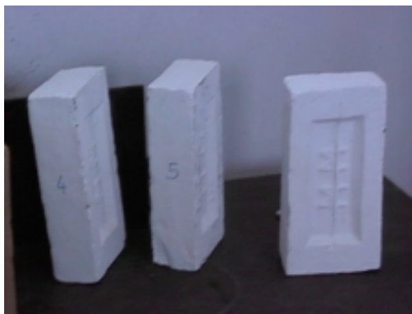
Foto 04- Corpos de Prova 4, 5 e 6 pintados para determinação dos volumes sólidos.
