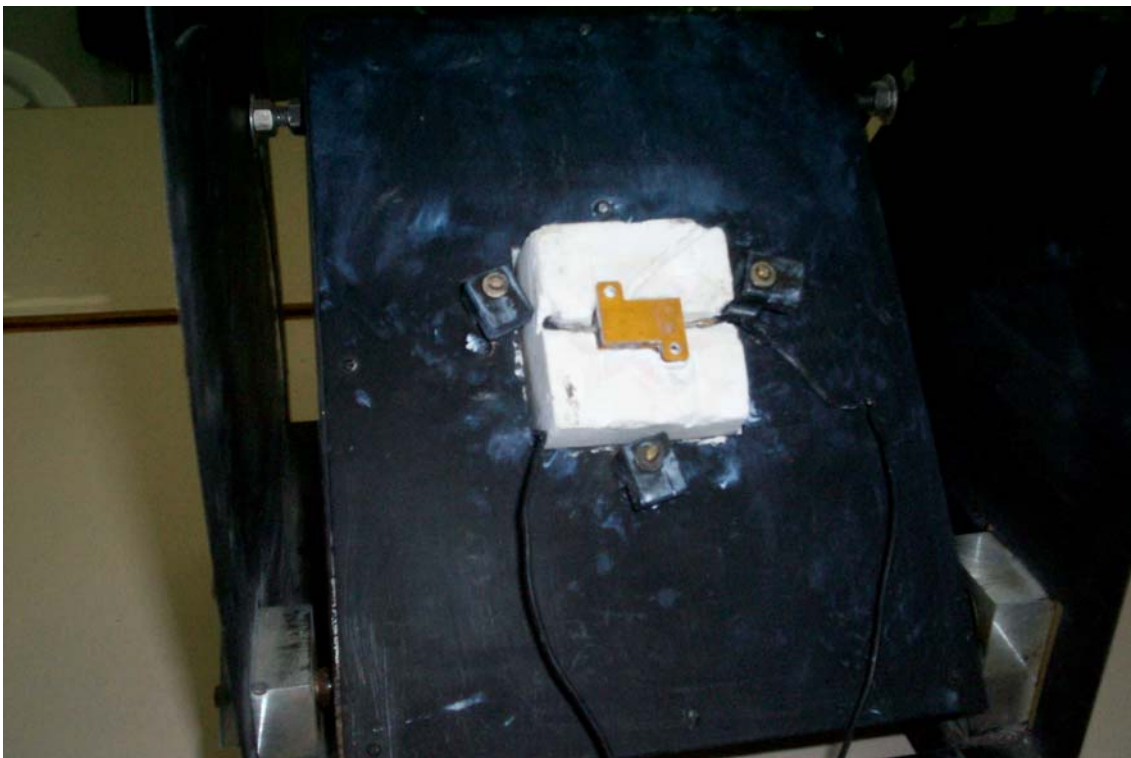
Figura 3.6 – Montagem do aquecedor no dispositivo ( na foto, para melhor visualização, o aquecedor não está totalmente encaixado no dispositivo)
