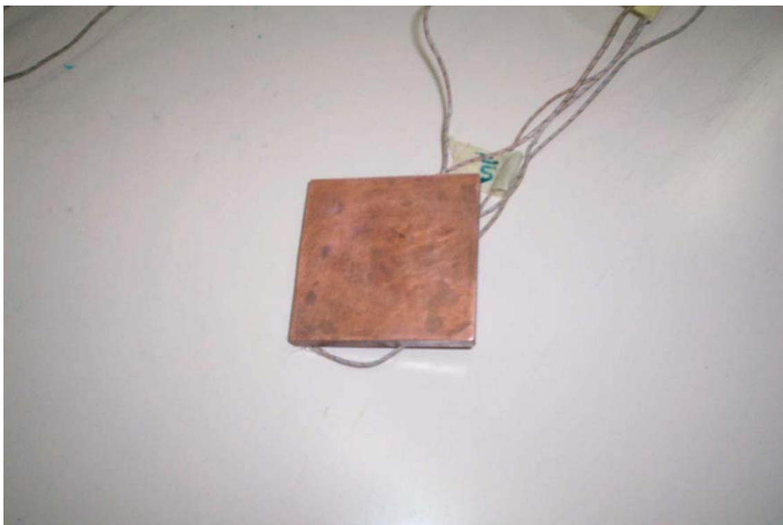
Figura 3.8 – Bloco de cobre utilizado como padrão
