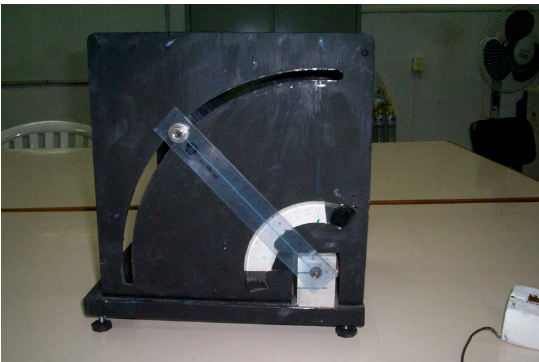
Figura 3.3 – Detalhe do sistema de inclinação
