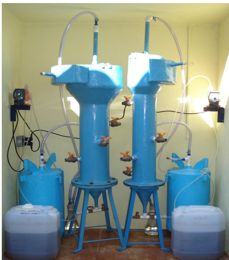
FIGURA 4. Foto do sistema de tratamento com os reatores anaeróbios UASB (R1 e R2).
