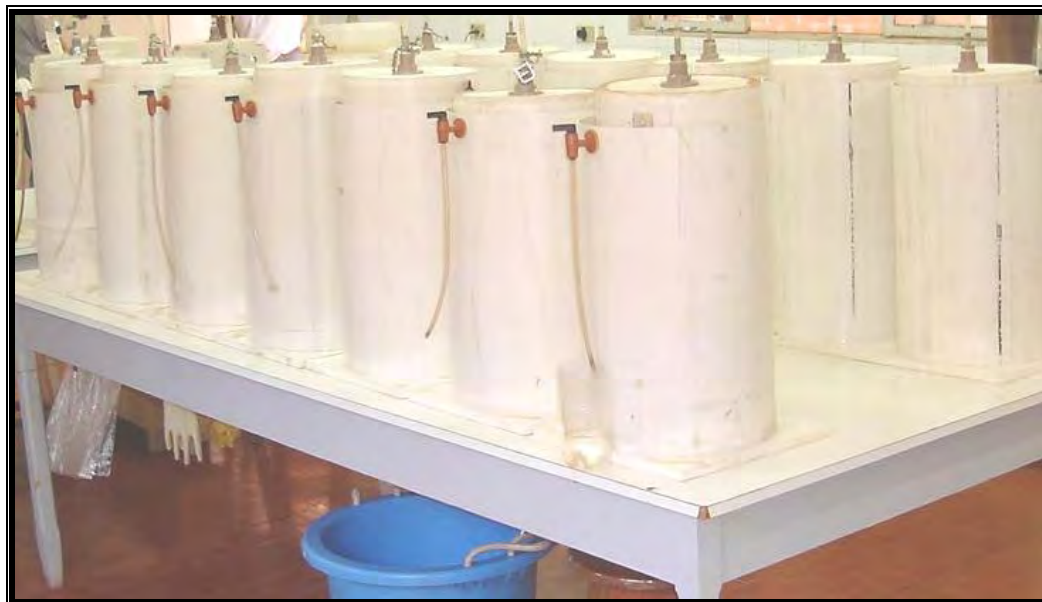
Figura 1. Biodigestores batelada de bancada, utilizados no ensaio de biodigestão.
