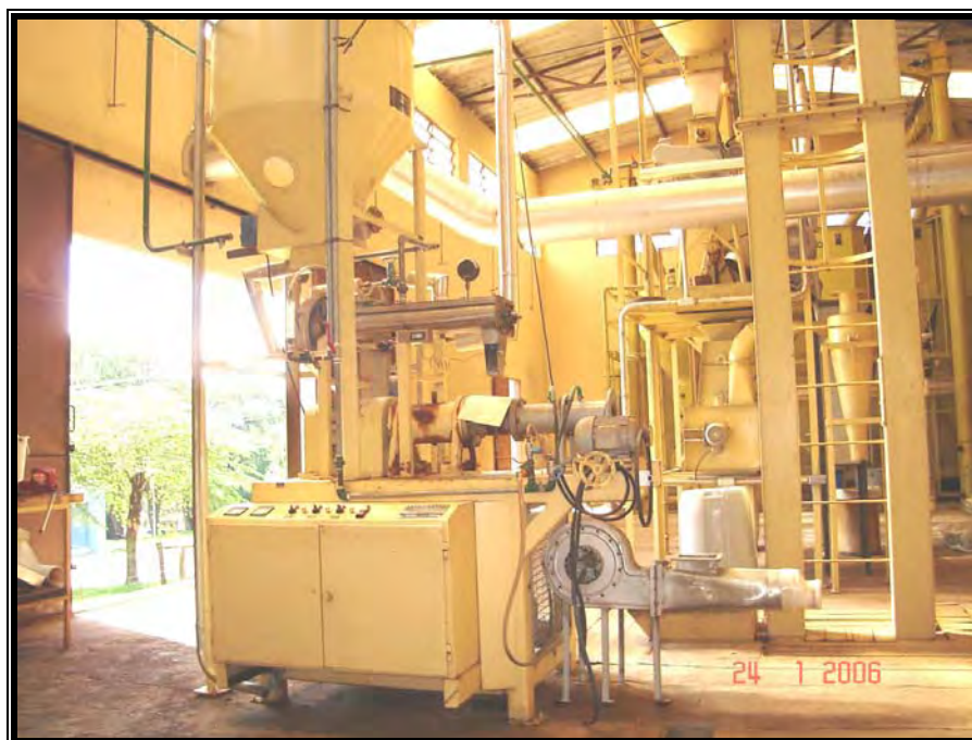
Figura 2. Extrusora utilizada na confecção dos concentrados experimentais.
